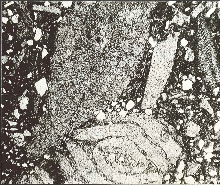
Microphoto 7 (L.M. 152) Chalets de Bossetan Orbitoïdes et petite Nummulite dans un calcaire du Priabo- nien inférieur . Nombreux quartz détritiques [ x 25 ]
