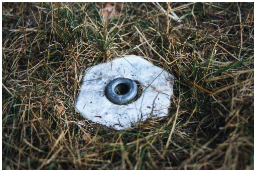
Photographie 3 – Borne type et clou d'arpentage type marquant les extrémités des profils topographiques.
