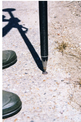
Photographie 3 – Borne type et clou d'arpentage type marquant les extrémités des profils topographiques.
