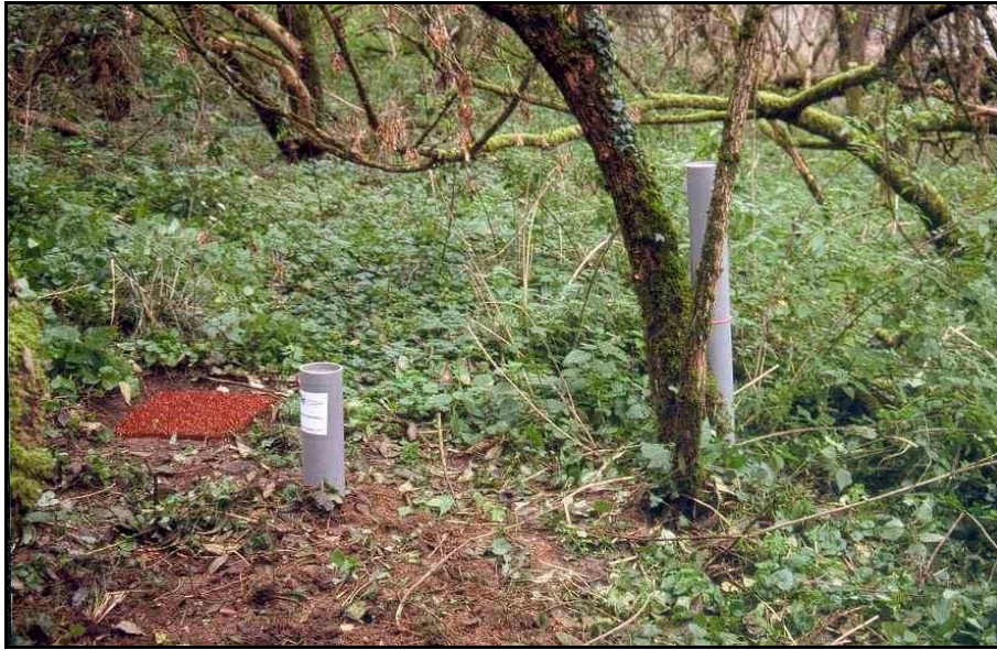
Photographie 5 – Point de mesure de la sédimentation sur un franc-bord. Trois niveaux de prélèvements assurent au même point un piégeage large des sédiments lors des submersions périodiques.
