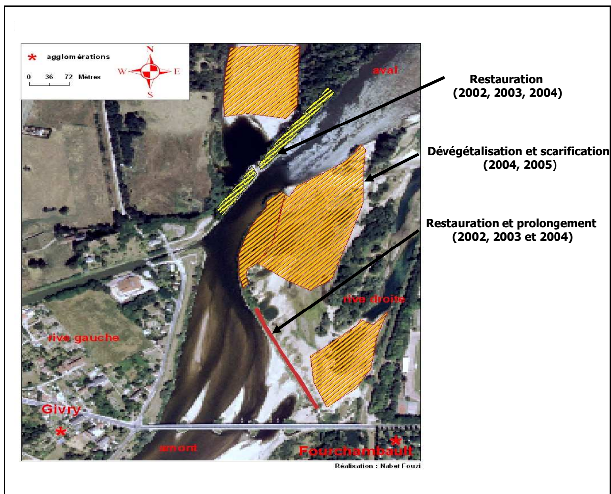
Figure 235 – Typologie et fréquence des travaux de restauration du lit (Site de Fourchambault).
