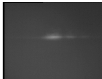
Figure 4. 89 - Photo en champ proche à 1550 nm d'un "ridge" inversé P3OT-PMMI
