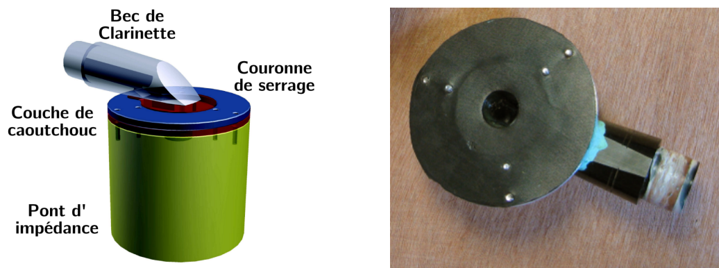
Figure 5.5 – Schéma et photo de l'interface bec-captur d'impédance.
