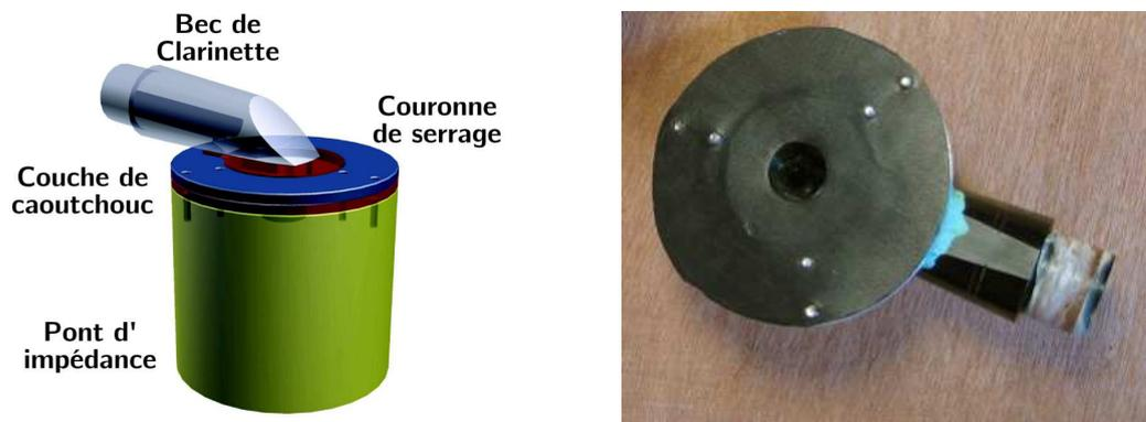
**Figure 5.5** – Schéma et photo de l'interface bec-captur d'impédance.
