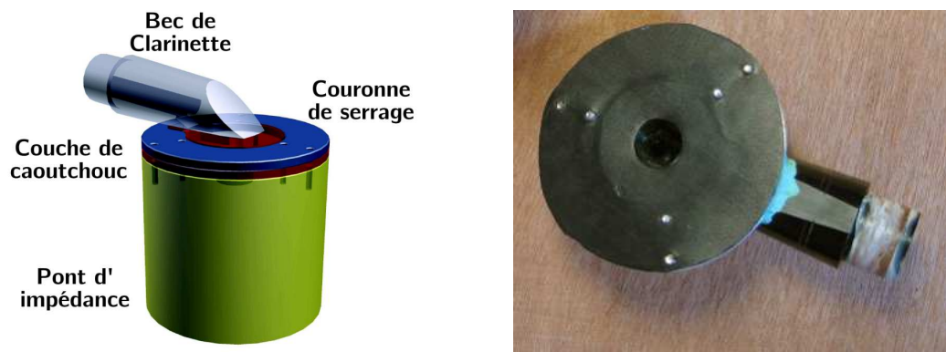
Figure 5.5 – Schéma et photo de l'interface bec-captur d'impédance.
