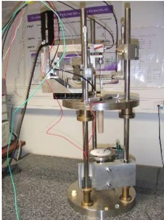
Figure 79 : Dispositif d'indentation instrumentée pour la mesure de la viscosité du verre
