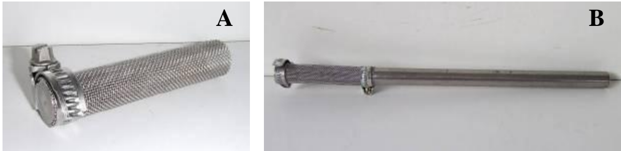
Figure 29 : Filtre pour retenir les billes lors de l'érosion des compacts. A : filtre fermé par un rond en inox ; B : filtre assemblé avec la tige
