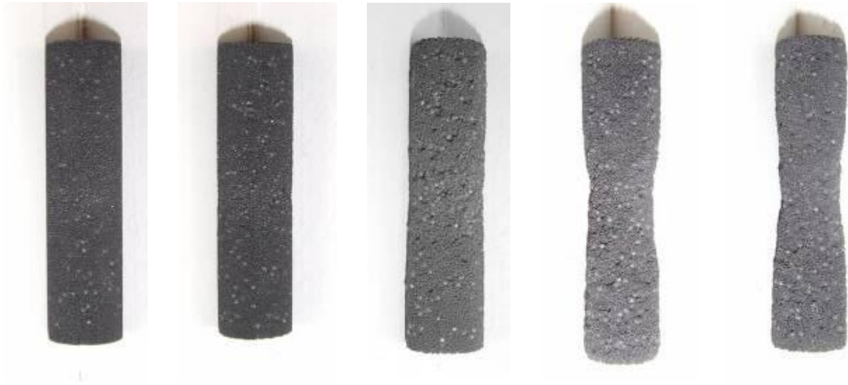
Figure 55 : Photographies du compact à 10 % érodé après 2 ; 4 ; 9 ; 14,75 et 17,5 h
