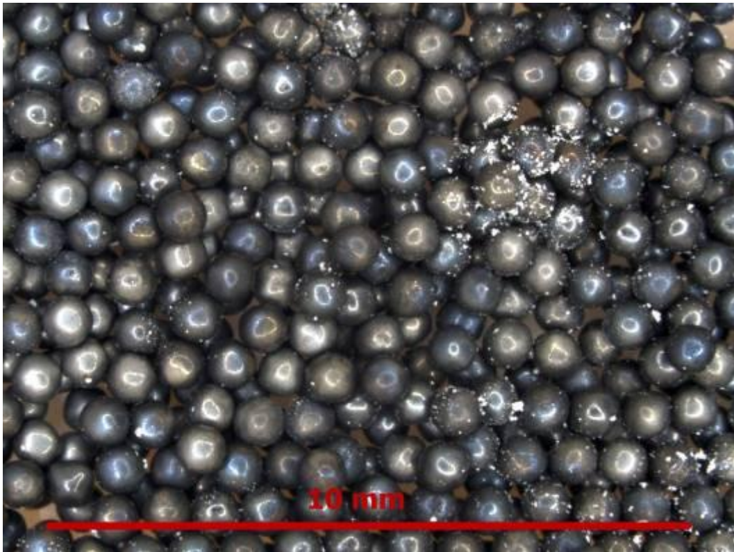
Figure 36 : Photo des résidus (TRISO sans oPyC et dépôt blanc) après combustion à 1100 K sous air pendant 16 h
