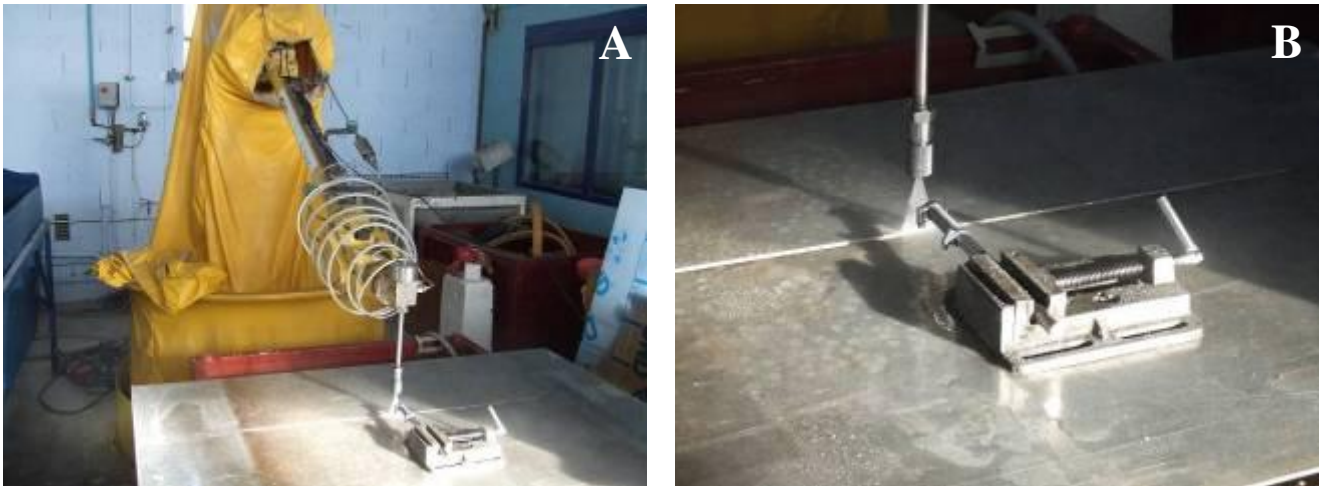
Figure 31 : A : Robot à tête 5 axes avec buse à jet plat ; B : Détail du jet, du filtre et de l'étai
