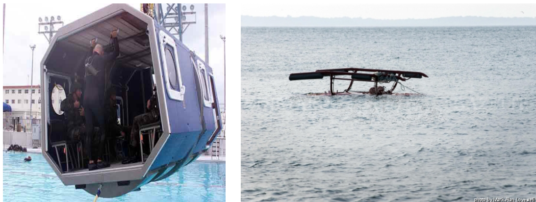
FIG. 1.7 – A gauche : Formation des personnels navigants à l'amerrissage d'urgence ( http://www.safetycenter.navy.mil ). A droite : Hélicoptère non équipé de système de flottabilité ( http://www.mvgazette.com/ )
