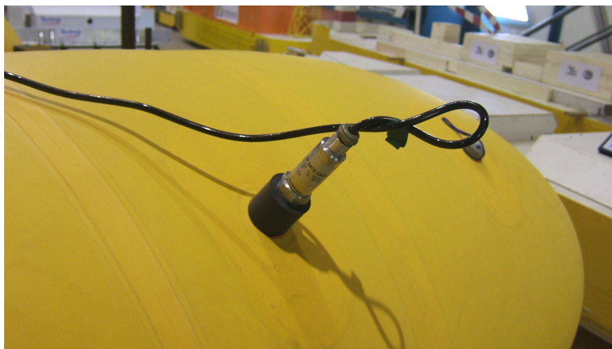
FIG. 7.9 – Capteur de pression utilisé pour mesurer à la fois la pression de gonflage et les variations de pression interne lors de l'impact
