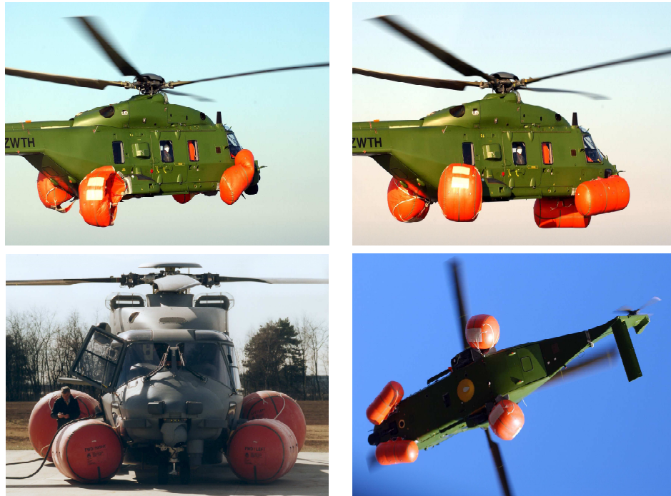
FIG. 1.6 – Système de flottabilité de l'hélicoptère militaire NH90 (photos Eurocopter)
