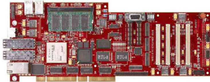
Figure 16. Carte PCI ReMIX comportant 64 Go de mémoire FLASH et un composant reconfigurable Xilinx Virtex-2 Pro.
