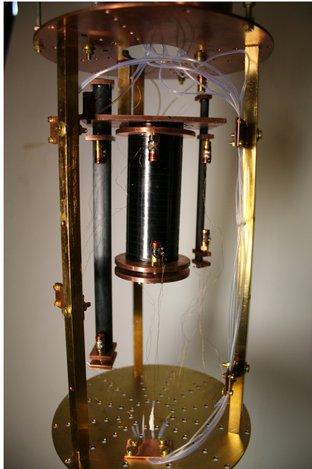
Figure A.16 – Photo du montage de l'expérience de conductivité. 2ème série d'échantillon
