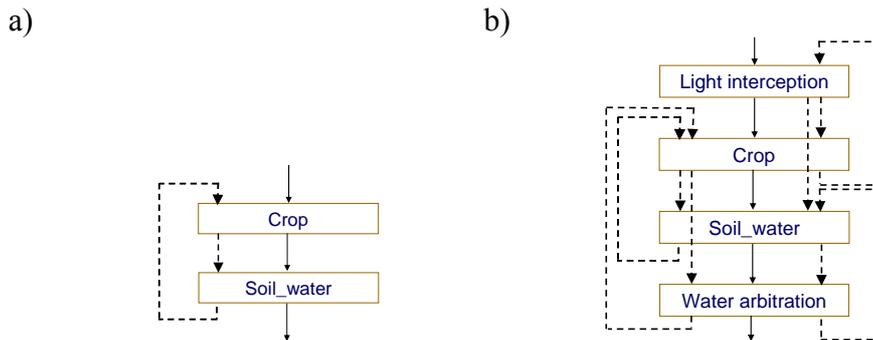
Figure 14 : Exemple de superposition de l'enchaînement d'appel et du besoin en données d'entrée des composants 'Crops' et 'Soil\_water' pour 2006 (a) et 2008 (b). (b) est issu de (van Evert et al., 2007). Les flèches en trait continu correspondent à la séquence d'appel des programmes. Les flèches en pointillé expriment le besoin en entrée de données de la part du composant à l'extrémité de la flèche.
