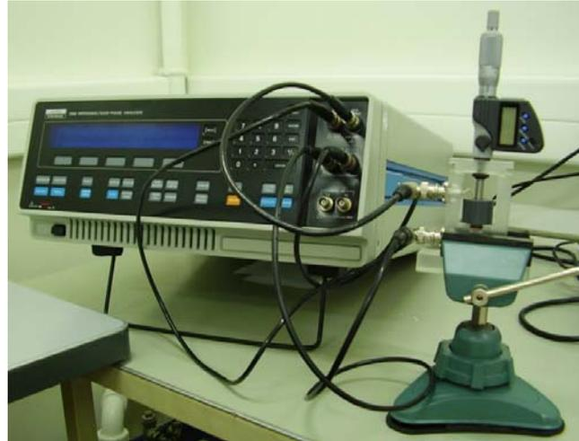
**Figure 58.** Dispositif utilisé pour les mesures diélectriques.
