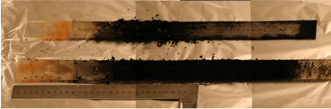
**Figure 17.** Photo de la plaque de quartz recouverte de CNTs (zones noires).
