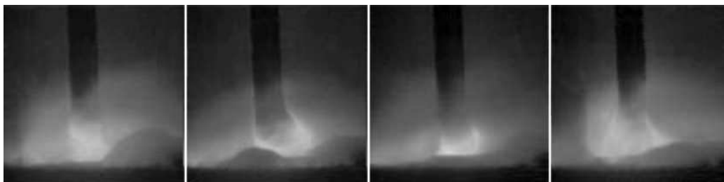
Fig. 1.4: Transfert par court-circuit dans l'arc MIG-MAG
