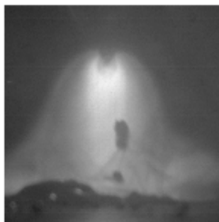
Fig. 5.20: Image de l'arc en fonctionnement sous Ar+20.2% obj CO 2 .
