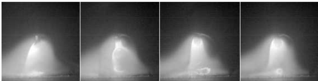
Fig. 1.5: Transfert globulaire dans l'arc MIG-MAG
