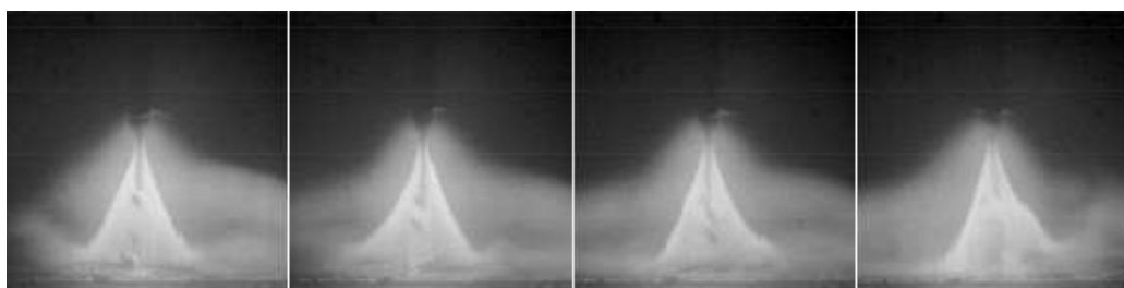
Rysunek 1.6: Natryskowy sposób przenoszenia metalu w łuku MIG.
