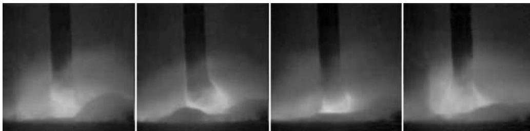
Rysunek 1.4: Zwarcioowy sposób przenoszenia metalu w łuku MIG.
