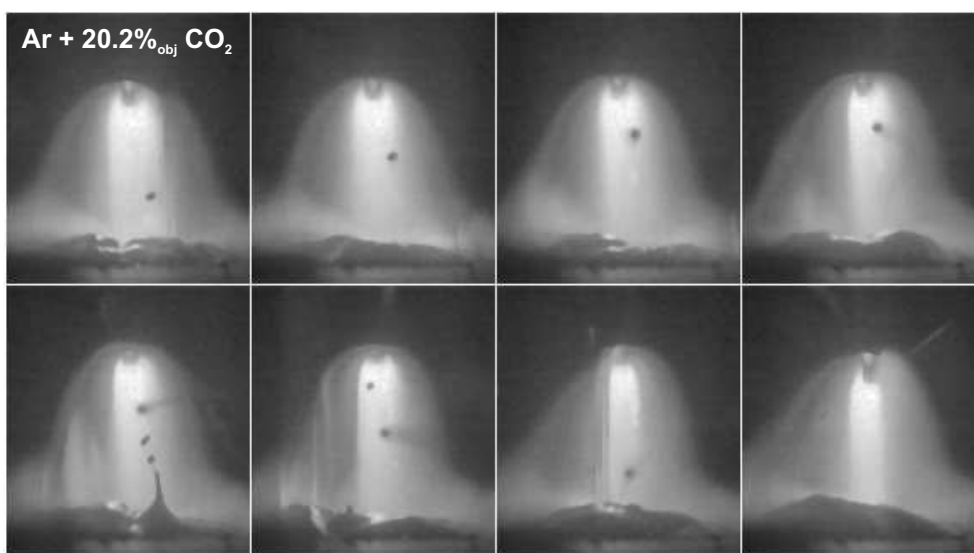
Rysunek 4.28: „Eksplzje” z powierzchni katody, obserwowane w procesie typu MAG. Parametry rejestracji obrazu: częstość = 109.8 obraz/s, czas = 9.1 ms, rozmiar obrazu = 144×144 pixele. Parametry startowe generatora: V_g = 20 l/min, I_{Moyen} = 326 A, I_{ArcOrigine} = 330 A, V_f = 9 m/min.
