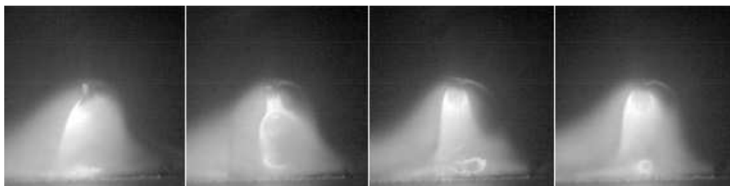
Rysunek 1.5: Grubokropłowy sposób przenoszenia metalu w łuku MIG.
