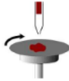
Figure 2-2:Schéma de principe du spin coating
