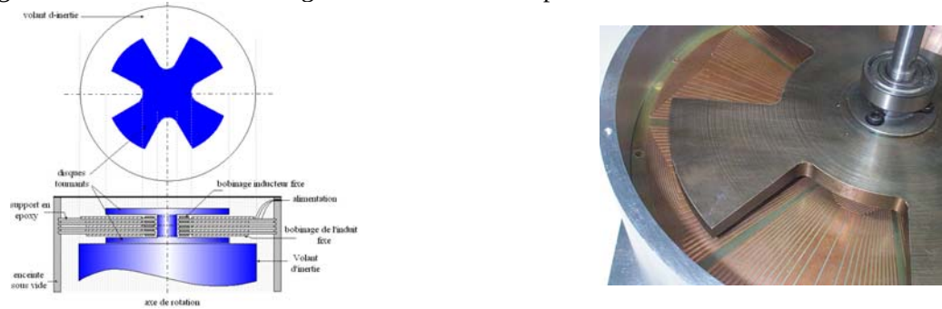
Figure 6. Architecture du moteur/générateur et photo de la maquette de validation
