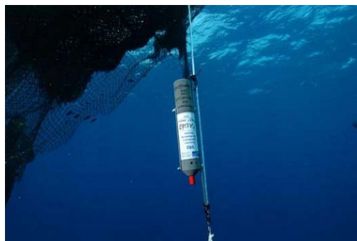
Figure 2-16 : Station d'écoute VR2 (Vemco) installée sous un DCP (source : FADIO, M. Taquet).
