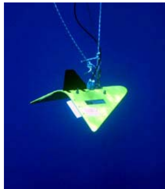
Figure 2-15 : Système de suivi actif utilisé lors des déplacements de dorades coryphènes. Il se compose de quatre hydrophones fixés sur une paravane tractée par le bateau et d'un récepteur (Vemco VR28). Les localisations du bateau sont mesurées à l'aide d'un GPS relié au récepteur. Un ordinateur enregistre les données en temps réel (source : C. Girard).
