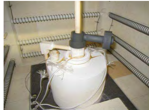
Figure III.3.31: Montage de la cellule et détails du système d'alimentation en gaz combustible et comburant du banc d'essais TOURNESOL.
