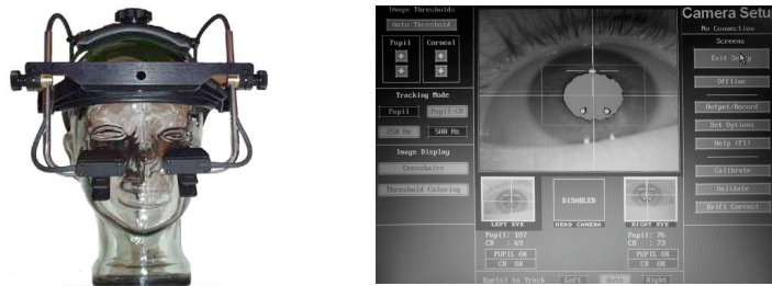
Figure 6.8. A gauche : casque et caméra de Eyelink II (source : http://www.sr-research.com ). A droite : visualisation pour les réglages de la pupille et du reflet cornéen.
