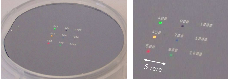
FIGURE 2.3: Photographie d'une plaquette d'échantillons de motifs d'aluminium sur silicium. Le pas de répétition des différents réseaux est indiqué en nanomètres. Ces dimensions étant dans la gamme de longueur d'onde du visible les réseaux apparaissent irisés.
