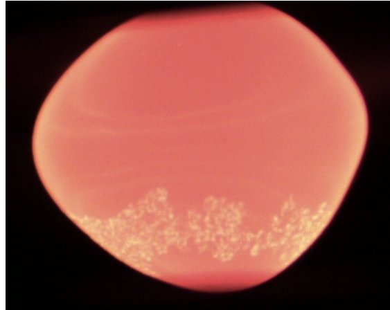
Figure 3.22: Répartition des précipités au niveau des zones mortes d'une bille de silicium.
