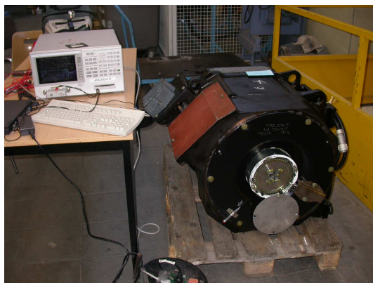
Figure 100. Dispositif de mesure d'impédance sur le moteur étudié
