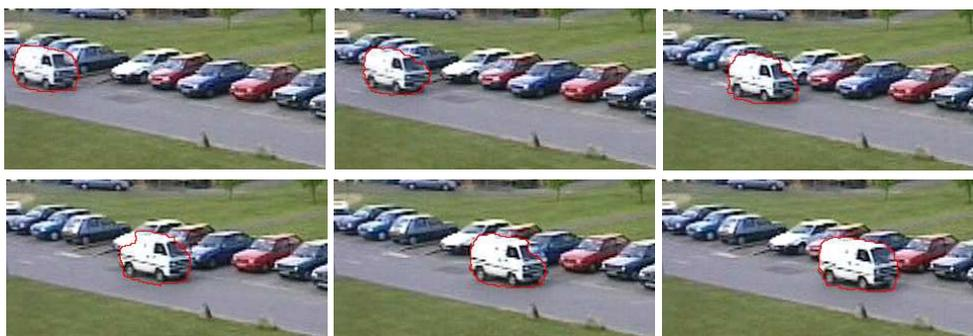
FIGURE 5.6 – Résultats de segmentation sur la séquence *PETS 2001* sans contrainte temporelle. Les frontières de mouvement sont superposées sur les images originales. Seules les images 702, 710, 725, 743, 751 et 758 sont montrées. La transparence du pare-brise de la camionnette explique les inconsistances temporelles de la segmentation.  $\lambda_1 = 17$ ,  $\lambda_2 = 0$ ,  $\lambda_3 = 0$  et  $\lambda_4 = 30$ .
