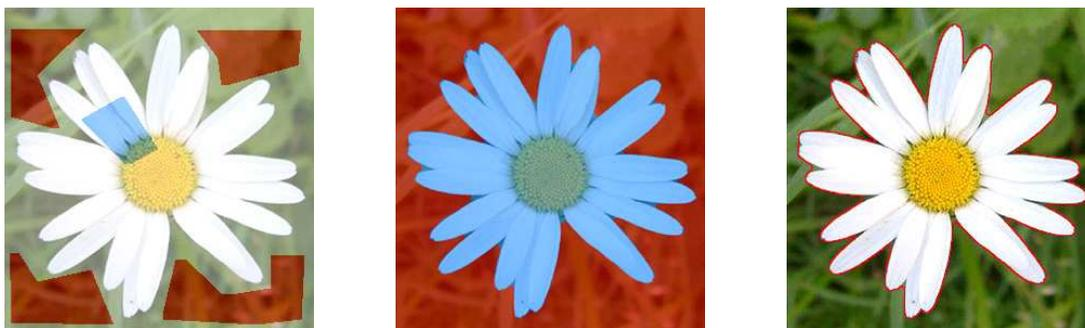
FIGURE 5.17 – Segmentation interactive d’une image seule. Cas classique de segmentation binaire d’une image seule.  $\lambda_1 = 0$ ,  $\lambda_2 = 1$  et  $\lambda_3 = 10$ . De gauche à droite : graines fournies par l’opérateur (les régions non marquées restent incertaines, à classer) ; carte de segmentation finale après classification automatique des régions incertaines ; superposition des frontières sur l’image originale.
