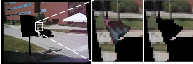
FIGURE 5.12 – Mosaïque de la couche « arrière-plan » pour l’instant de référence 17. De gauche à droite : mosaïque obtenue automatiquement à la fin de la première passe, détail du carré blanc qui inclut par erreur certaines zones de la voiture, suppression de ces erreurs par une modeste intervention de l’opérateur. En noir, les trous restants dans la mosaïque, c’est-à-dire les régions qui selon notre système n’ont jamais été visibles durant l’intervalle considéré.
