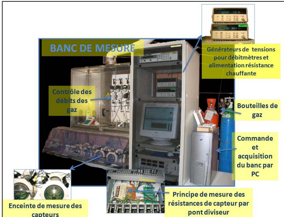
Figure 1 Banc industriel pour mesures isothermes du LCC
