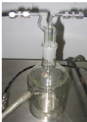
Figure 5 Barboteur avec double enveloppe contenant l'eau du bain et l'éthylène-glycol. Photo du bain thermostaté utilisé.
