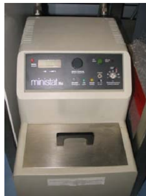
Figure 5 Barboteur avec double enveloppe contenant l'eau du bain et l'éthylène-glycol. Photo du bain thermostaté utilisé.
