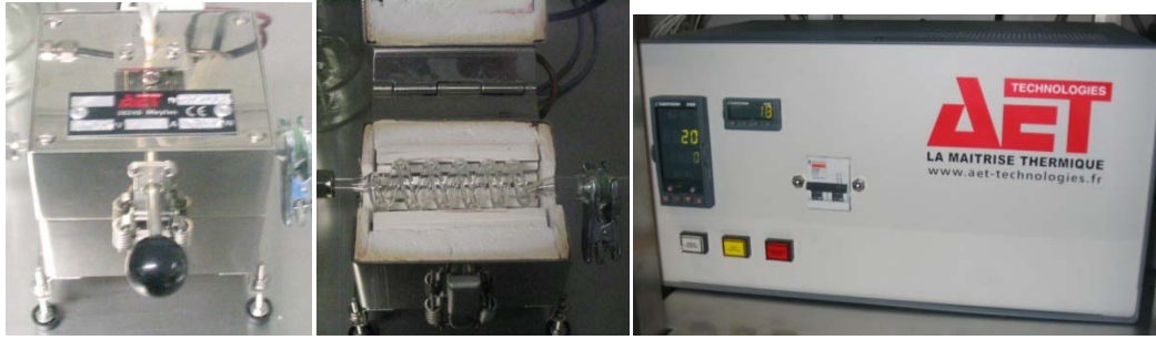
Figure 6 Mini Four utilisé (système fermé et ouvert. On peut observer le serpentin à l'intérieur de la zone de chauffage. Photo des modules Eurotherme de pilotage.
