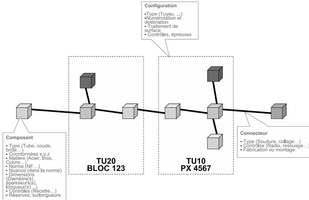
Figure 5.7 – Représentation schématique d'une modélisation de tuyauterie sous forme d'une architecture logicielle.
