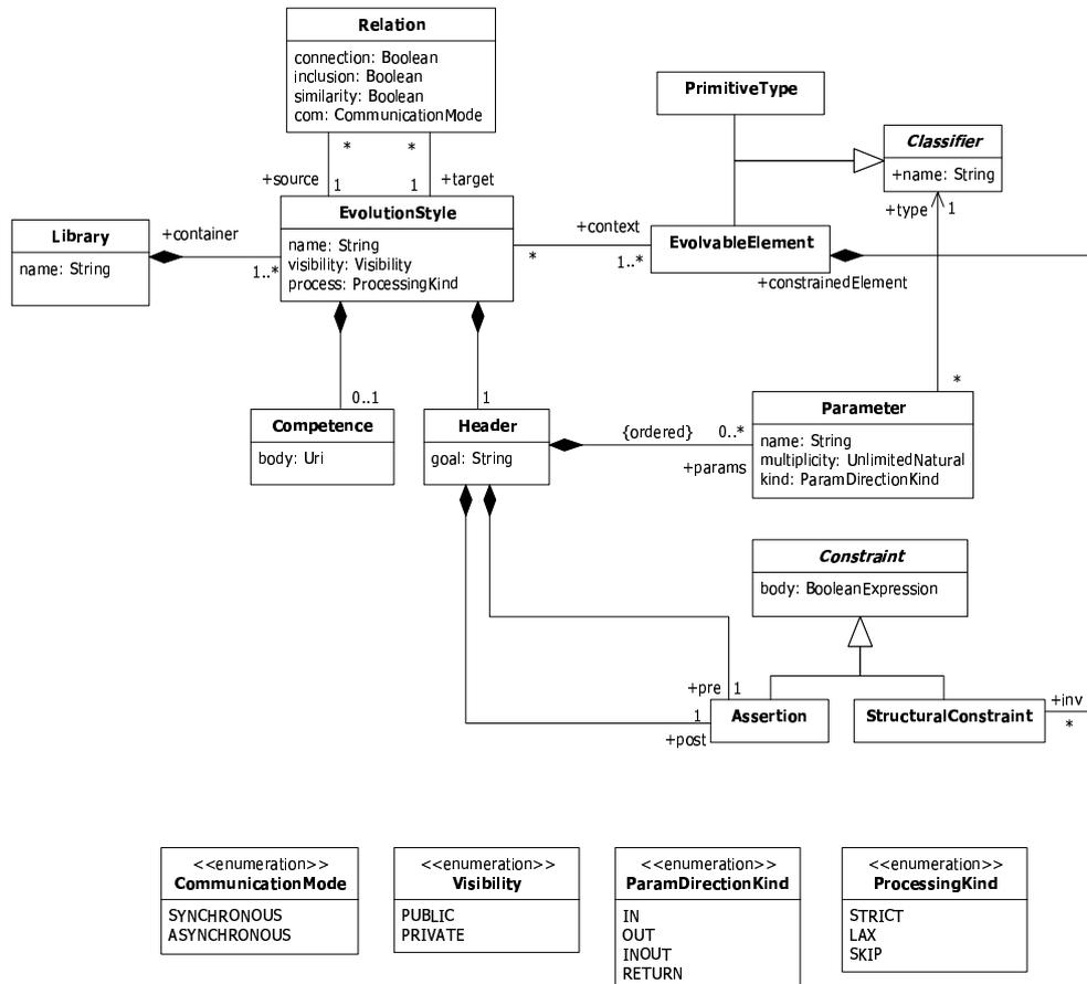
Figure 3.3 – La structure du méta-modèle noyau de SAEM.
