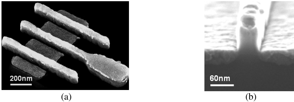
Fig. 123 : Observation MEB des transistors Schottky en vue « tiltée » (a), et en coupe (b).
