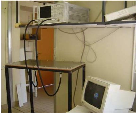
FIG. 1.13 – *Dispositif expérimental composé d'une cavité micro-ondes et d'un analyseur de réseau vectoriel piloté par ordinateur .*
