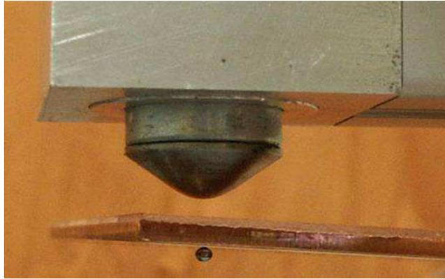
FIG. 2.16 – Dispositif contenant les 4 aimants et permettant le déplacement de la bille.
