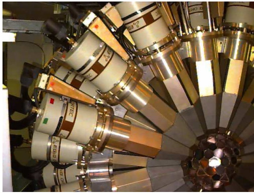
Figure 1.1: Zoom sur l'intérieur du multidétecteur GAMMASPHERE lorsqu'il était installé sur une ligne de faisceau du cyclotron 88" au LBL.
