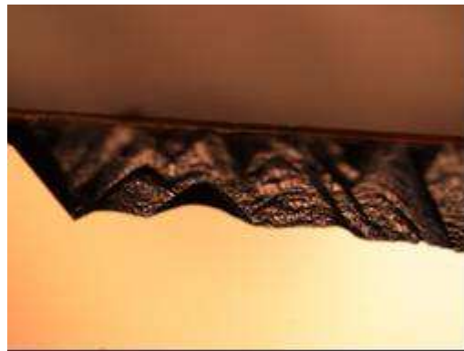
Figure I.B-23 : gravure anisotrope de l'InP, facette pyramidale sur un bord de substrat
