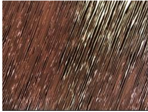
Figure I.B-22 : rugosité de surface lors d'une gravure par HCl de l'InP
