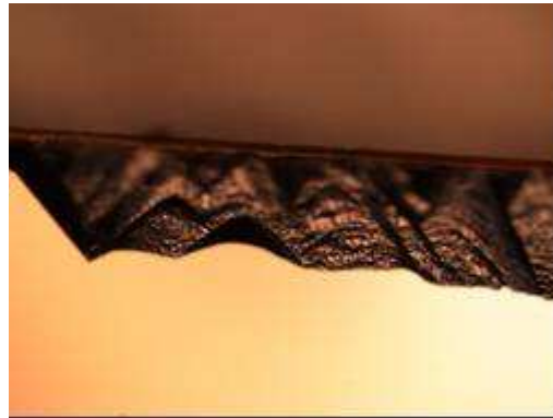
Figure I.B-23 : gravure anisotropique de l'InP, facette pyramidale sur un bord de substrat
