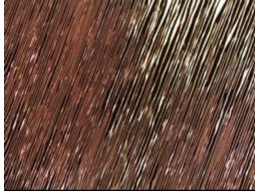
Figure I.B-22 : rugosité de surface lors d'une gravure par HCl de l'InP
