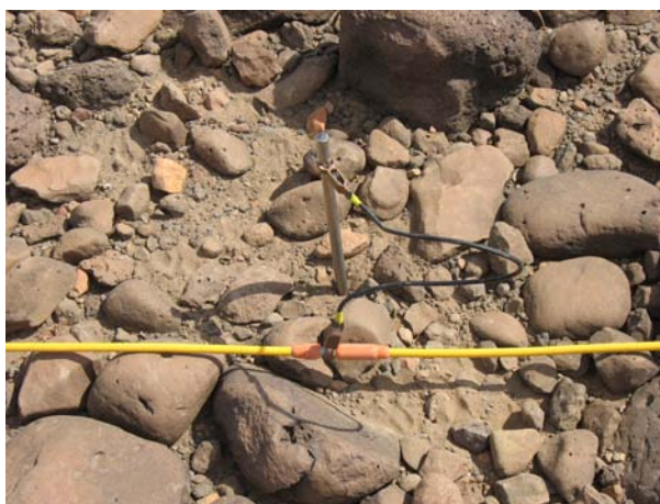
(b) Une portion d'un panneau électrique sur le SEH avec câble, connecteur et électrode
