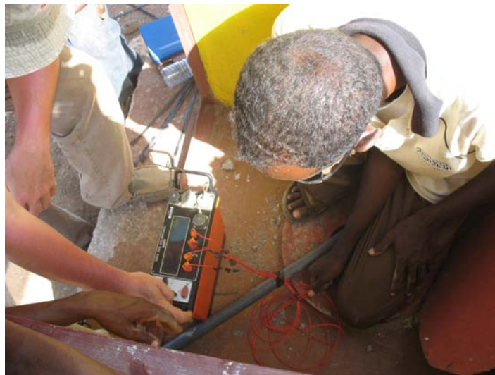
FIG. 5.43: Mesure de la distribution de la résistivité en forage.
