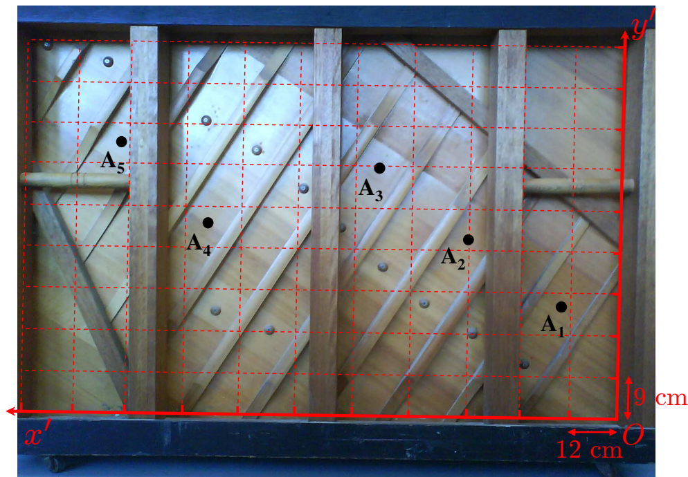
FIG. 3.13 – Maillage expérimental de la table et emplacement des accéléromètres, pour l'analyse modale par excitation impulsionnelle.
