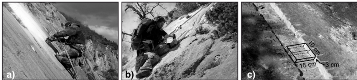
FIG. 5.2 : Photographies de terrain montrant la technique d'échantillonnage des escarpements calcaires de failles normales actives pour l'identification des phases d'exhumation sismique via les isotopes du chlore. a) phase de sciage à la disqueuse, b) phase d'extraction des échantillons au marteau et au burin, c) vue de la trace de l'échantillonnage.
