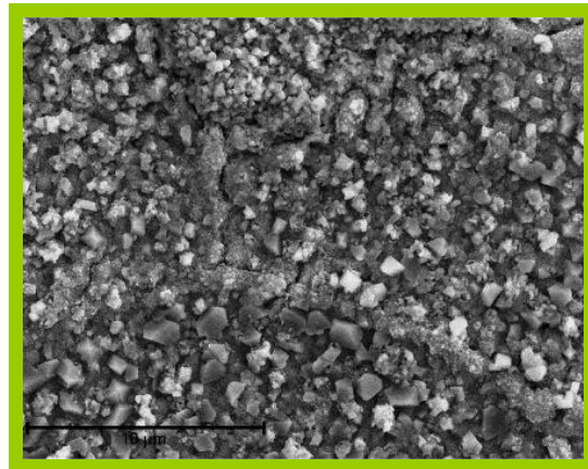
Figure IV.35 : Observation MEB de l'alliage Haynes230 revêtu de La_2O_3 pré-oxydé après oxydation sous H_2/10\%H_2O sous 150 mbar pendant 100 h à 800°C.
