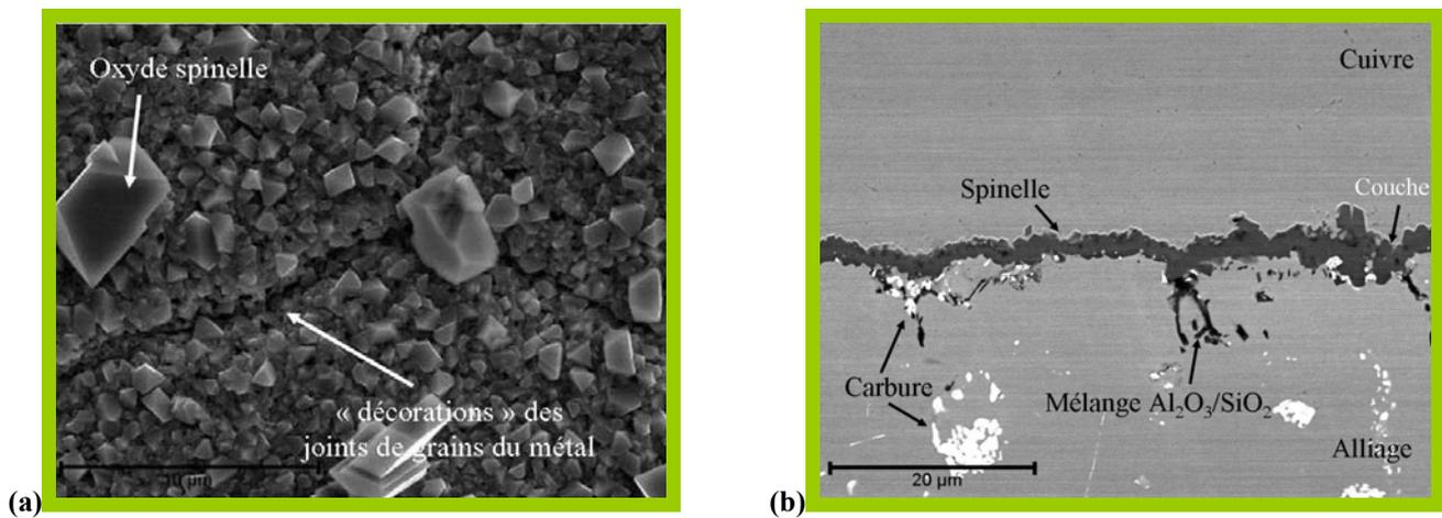
Figure V.13 : Observation MEB de l'alliage Haynes230 revêtu de La<sub>2</sub>O<sub>3</sub> après oxydation sous air à la pression atmosphérique pendant 320 jours à 800°C. (a) Image en électrons secondaires de la surface. (b) Image en électrons rétrodiffusés d'une coupe transversale.
