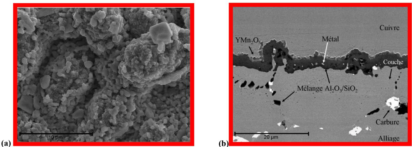
Figure V.29 : Observation MEB de l'alliage Haynes230 revêtu de Y<sub>2</sub>O<sub>3</sub> après oxydation sous air à la pression atmosphérique pendant 640 jours à 800°C. (a) Image en électrons secondaires de la surface. (b) Image en électrons rétrodiffusés d'une coupe transversale.
