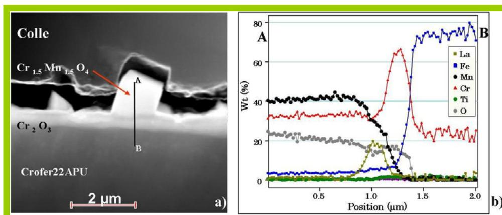
Figure III.18 : Observation MET HAADF (High Angle Annular Dark Field) (a) et spectre EDX (b) d'une coupe transverse de l'acier Crofer22APU revêtu de  $La_2O_3$  après 100 h à 800°C sous air à la pression atmosphérique
