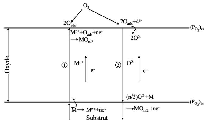
Figure I.8 : Mécanismes de diffusion dans une couche d'oxyde [40]
