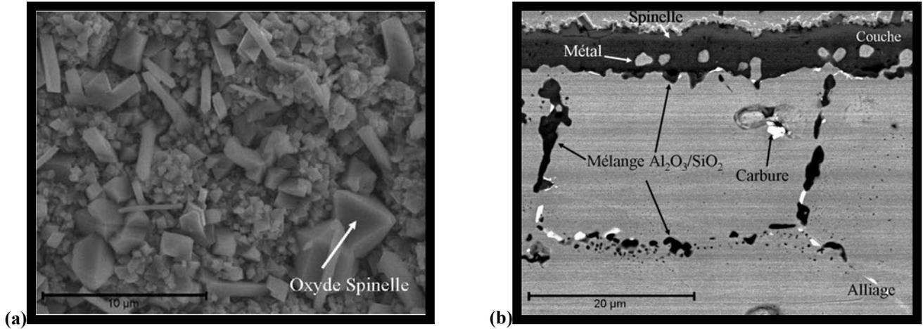
Figure V.27 : Observation MEB de l'alliage Haynes230 non revêtu après oxydation sous air à la pression atmosphérique pendant 640 jours à 800°C. (a) Image en électrons secondaires de la surface. (b) Image en électrons rétrodiffusés d'une coupe transversale.
