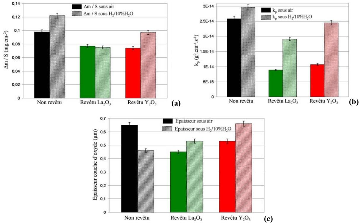
Figure III.27 : Comparaison de  $\Delta m/S$  (a), de  $k_p$  (b) et de l'épaisseur des couches d'oxyde (c) sur l'acier Crofer22APU non revêtu et revêtu de RE<sub>2</sub>O<sub>3</sub> après 100 h sous air et sous H<sub>2</sub>/H<sub>2</sub>O à 800°C
