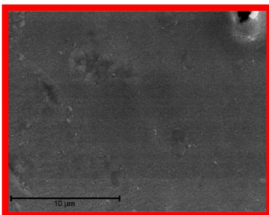
Figure IV.32 : Observation MEB de l'acier Crofer22APU revêtu de  $Y_2O_3$  pré-oxydé après oxydation sous  $H_2/10\%H_2O$  sous 150 mbar pendant 100 h à 800°C.
