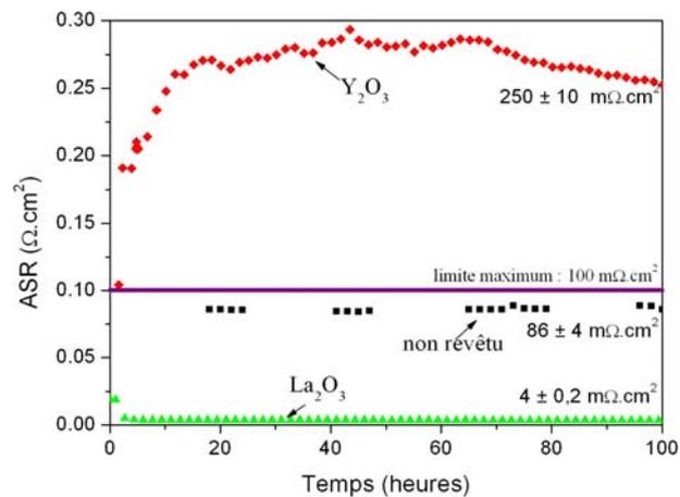
Figure III.21: Courbes ASR de l'acier Crofer22APU non revêtu et revêtu de RE<sub>2</sub>O<sub>3</sub> pendant 100 h à 800°C sous air à la pression atmosphérique
