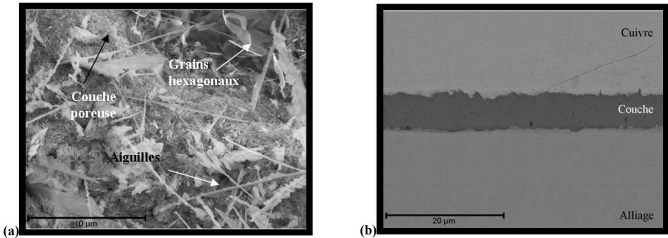
Figure III.33 : Observation MEB de l'acier Fe30Cr non revêtu après oxydation sous  $H_2/10\%H_2O$  sous 150 mbar pendant 100 h à 800°C. (a) Image en électrons secondaires de la surface. (b) Image en électrons secondaires d'une coupe transversale.
