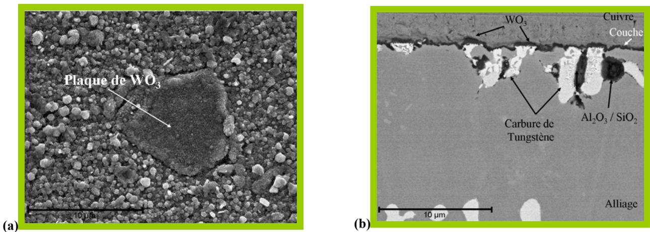
Figure III.12 : Observation MEB de l'Haynes230 revêtu de  $\text{La}_2\text{O}_3$  après oxydation sous air à la pression atmosphérique pendant 100 h à 800°C. (a) Image en électrons secondaires de la surface. (b) Image en électrons rétrodiffusés d'une coupe transversale.
