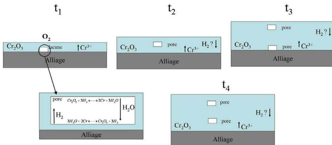
Figure VI.14 : Schéma du développement d'une couche de chromine sous H<sub>2</sub>/H<sub>2</sub>O
