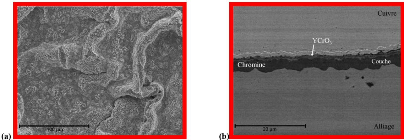
Figure V.40 : Observation MEB de l'acier Fe30Cr revêtu de  $\text{Y}_2\text{O}_3$  pré-oxdé après oxydation sous air à la pression atmosphérique pendant 320 jours à 800°C. (a) Image en électrons secondaires de la surface. (b) Image en électrons rétrodiffusés d'une coupe transversale.
