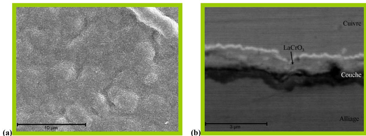
Figure IV.3 : Observation MEB de l'acier Fe30Cr revêtu de  $\text{La}_2\text{O}_3$  après 2 h de pré-oxydation à  $1\ 000^\circ\text{C}$  sous air à la pression atmosphérique. (a) Image en électrons secondaires de la surface. (b) Image en électrons rétrodiffusés d'une coupe transversale.
