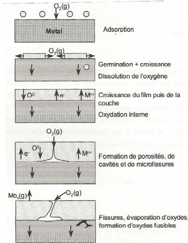
Figure I.5 : Illustration de la réaction métal-oxygène [30]
