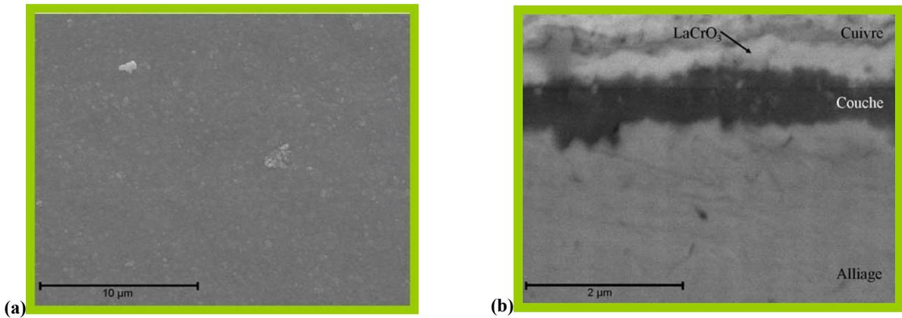
Figure III.9 : Observation MEB de l'acier Fe30Cr revêtu de  $\text{La}_2\text{O}_3$  après oxydation sous air à la pression atmosphérique pendant 100 h à 800°C. (a) Image en électrons secondaires de la surface. (b) Image en électrons rétrodiffusés d'une coupe transversale.
