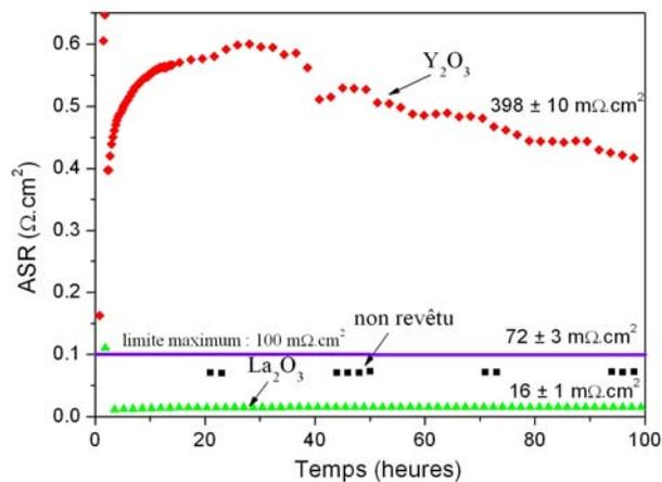
Figure III.23 : Courbes ASR de l'alliage Haynes230 non revêtu et revêtu de RE<sub>2</sub>O<sub>3</sub> pendant 100 h à 800°C sous air à la pression atmosphérique
