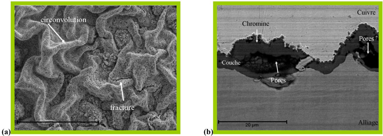
Figure V.25 : Observation MEB de l'acier Fe30Cr revêtu de  $\text{La}_2\text{O}_3$  après oxydation sous air à la pression atmosphérique pendant 640 jours à 800°C. (a) Image en électrons secondaires de la surface. (b) Image en électrons rétrodiffusés d'une coupe transversale.
