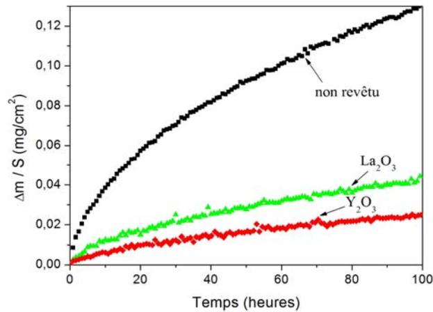
Figure III.26 : Courbes cinétiques des oxydations réalisées sur l'alliage Haynes230 non revêtu et revêtu de  $RE_2O_3$  oxydé 100 h à 800°C sous  $H_2/10\%H_2O$  sous 150 mbar
