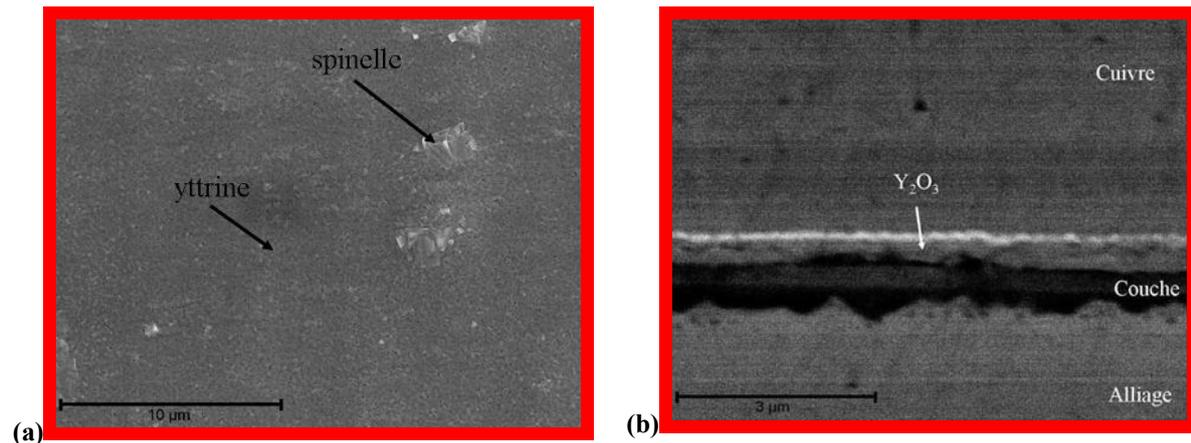
Figure IV.4 : Observation MEB de l'alliage Haynes230 revêtu de  $Y_2O_3$  après 2 h de pré-oxydation à  $1000^\circ C$  sous air à la pression atmosphérique. (a) Image en électrons secondaires de la surface. (b) Image en électrons rétrodiffusés d'une coupe transversale.
