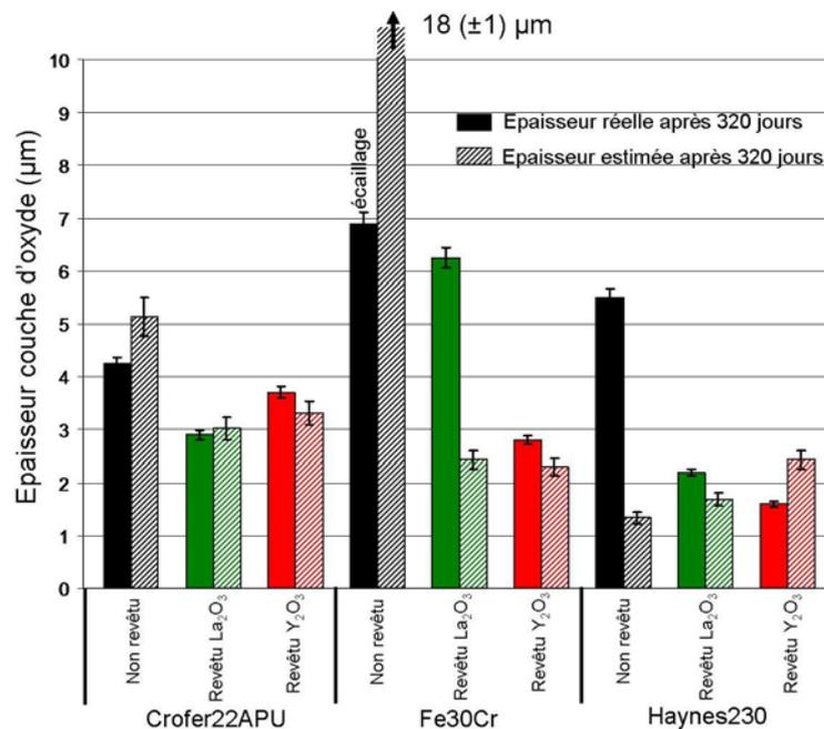
Figure V.15 : Epaisseur des couches d'oxyde réelle et estimée des alliages Crofer22APU, Fe30Cr et Haynes230 non revêtus et revêtus de RE<sub>2</sub>O<sub>3</sub> après 320 jours sous air à la pression atmosphérique à 800°C
