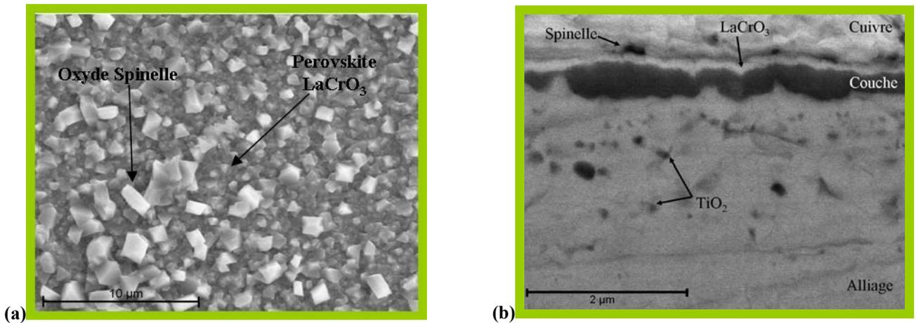
Figure III.5 : Observation MEB de l'acier Crofer22APU revêtu de La<sub>2</sub>O<sub>3</sub> après oxydation sous air à la pression atmosphérique pendant 100 h à 800°C. (a) Image en électrons secondaires de la surface. (b) Image en électrons rétrodiffusés d'une coupe transversale.
