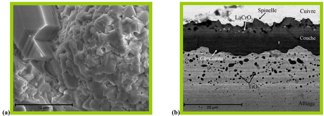
Figure V.22 : Observation MEB de l'acier Crofer22APU revêtu de  $\text{La}_2\text{O}_3$  après oxydation sous air à la pression atmosphérique pendant 640 jours à 800°C. (a) Image en électrons secondaires de la surface. (b) Image en électrons rétrodiffusés d'une coupe transversale.
