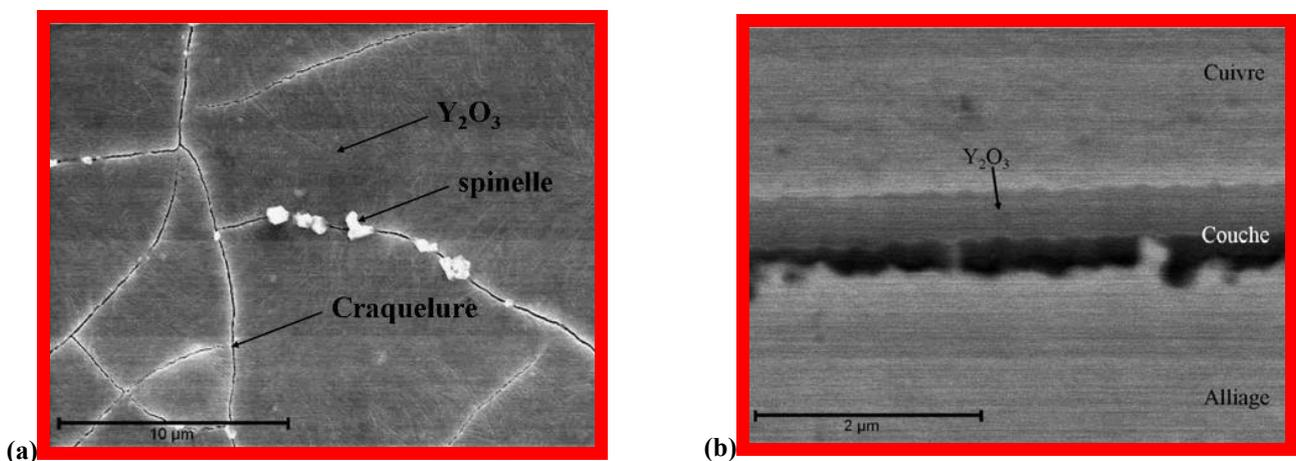
Figure III.13 : Observation MEB de l'Haynes230 revêtu de  $\text{Y}_2\text{O}_3$  après oxydation sous air à la pression atmosphérique pendant 100 h à 800°C. (a) Image en électrons secondaires de la surface. (b) Image en électrons rétrodiffusés d'une coupe transversale.
