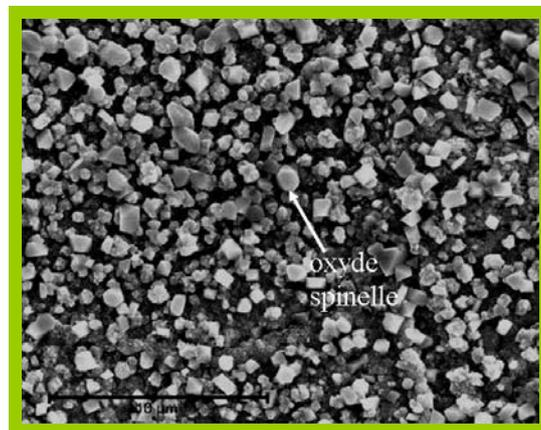
**Figure IV.20 :** Observation MEB de l'alliage Haynes230 revêtu de  $\text{La}_2\text{O}_3$  pré-oxdé après oxydation sous air à la pression atmosphérique pendant 100 h à 800°C.
