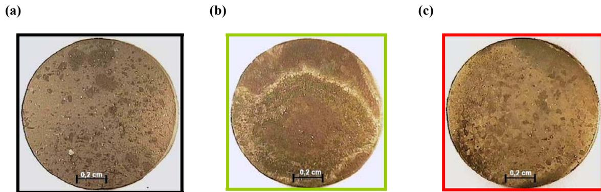
Figure V.18 : Observation macroscopique de l'alliage  $\text{Fe}_{30}\text{Cr}$  non revêtu (a), revêtu de  $\text{La}_2\text{O}_3$  (b) et revêtu d' $\text{Y}_2\text{O}_3$  (c) après 640 jours d'oxydation sous air à la pression atmosphérique à  $800^\circ\text{C}$ .
