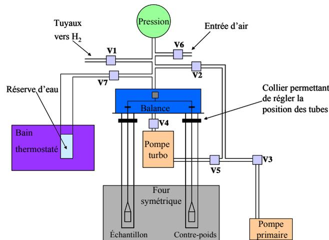
Figure II.2 : Schéma de la thermobalance  $H_2/H_2O$
