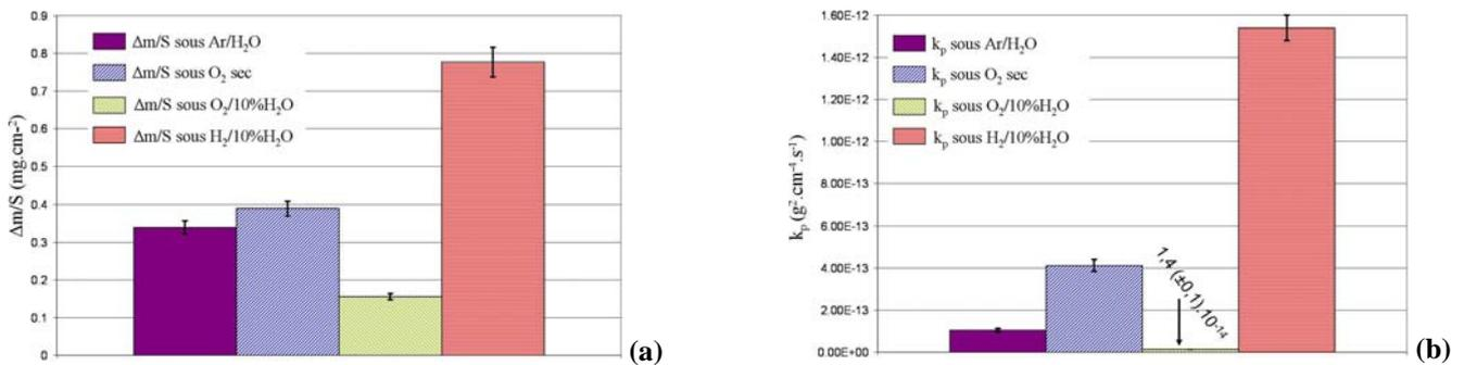
Figure VI.9 : Comparaison de  $\Delta m/S$  (a) et de  $k_p$  (b) sur l'acier Fe30Cr non revêtu oxydé pendant 100 h à 800°C sous Ar/10%H<sub>2</sub>O, O<sub>2</sub> sec, O<sub>2</sub>/10%H<sub>2</sub>O et sous H<sub>2</sub>/10%H<sub>2</sub>O sous 150 mbar
