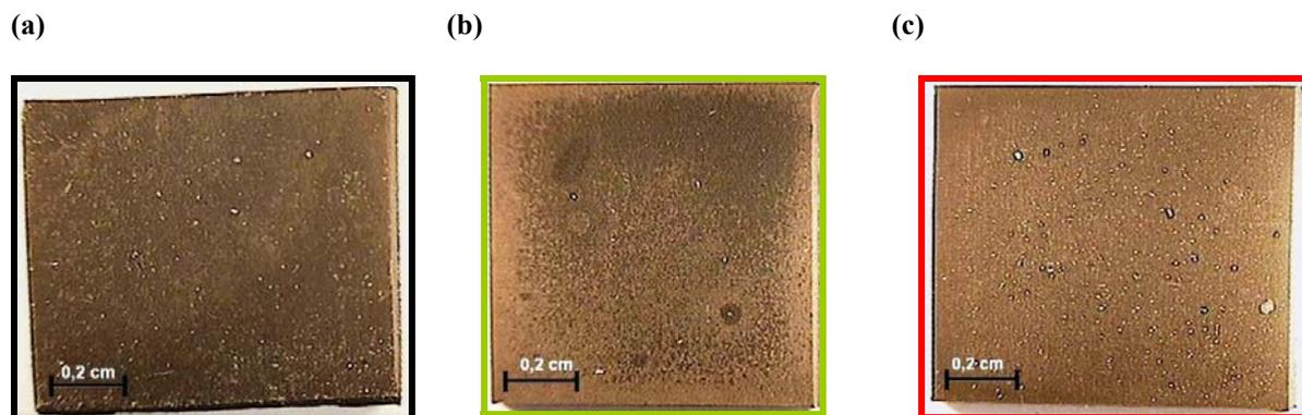
Figure V.19 : Observation macroscopique de l'alliage Haynes230 non revêtu (a), revêtu de  $\text{La}_2\text{O}_3$  (b) et revêtu d' $\text{Y}_2\text{O}_3$  (c) après 640 jours d'oxydation sous air à la pression atmosphérique à  $800^\circ\text{C}$ .
