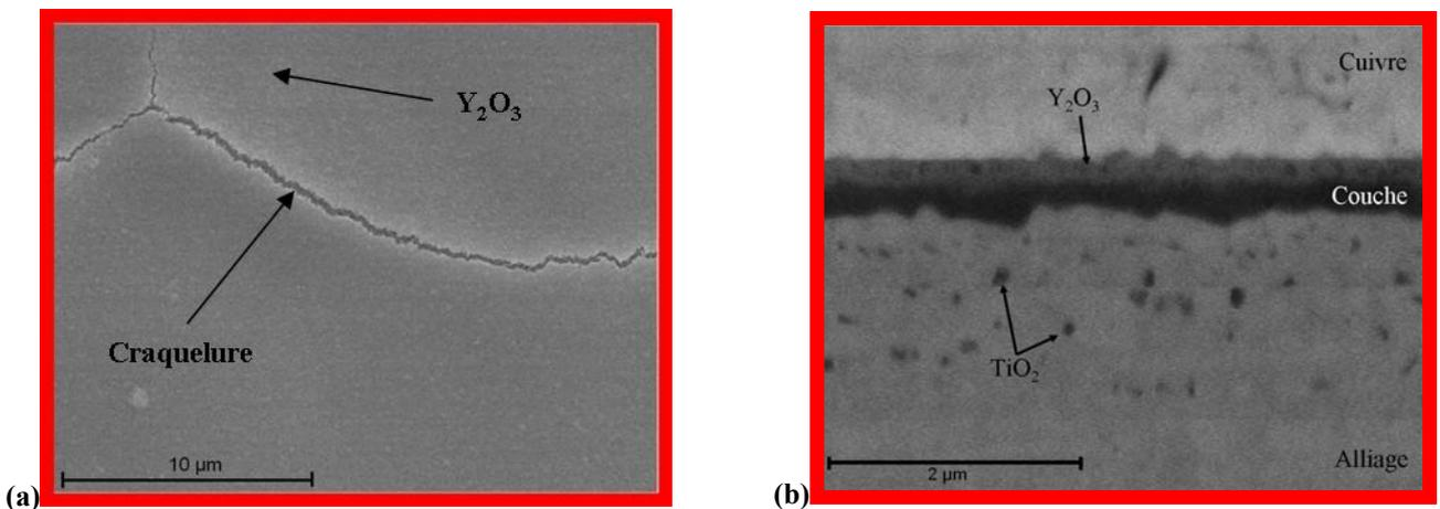
Figure III.6 : Observation MEB de l'acier Crofer22APU revêtu de Y<sub>2</sub>O<sub>3</sub> après oxydation sous air à la pression atmosphérique pendant 100 h à 800°C. (a) Image en électrons secondaires de la surface. (b) Image en électrons rétrodiffusés d'une coupe transversale.
