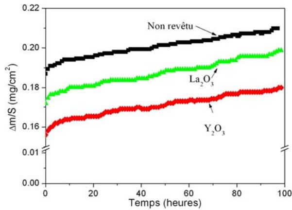
Figure IV.7 : courbes cinétiques des oxydations réalisées sur l'alliage Crofer22APU non revêtu et revêtu de RE<sub>2</sub>O<sub>3</sub> pré-oxylé puis oxydé 100 h à 800°C sous air à la pression atmosphérique
