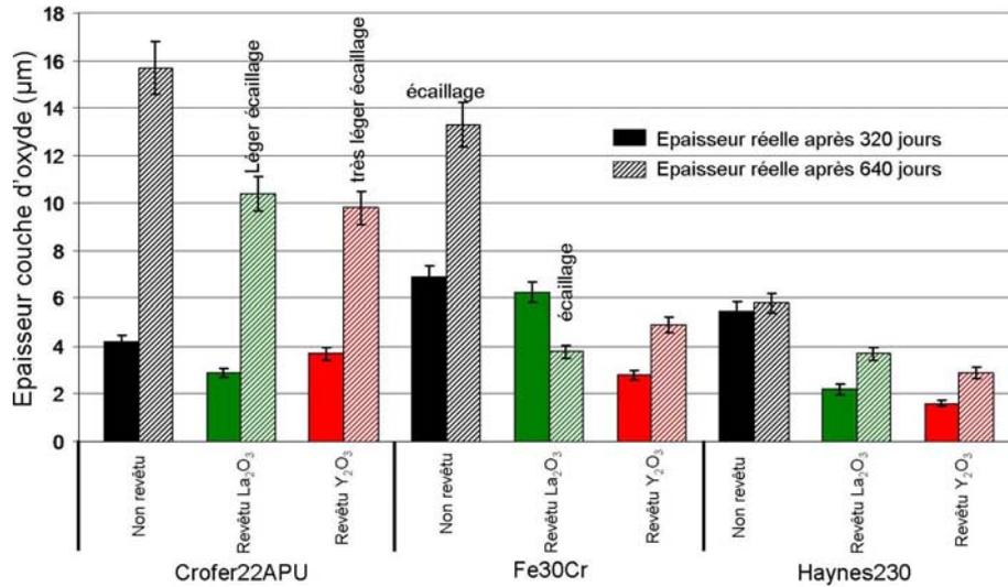
Figure V.30 : Epaisseur réelle des couches d'oxyde des alliages Crofer22APU, Fe30Cr et Haynes230 non revêtus et revêtus de RE<sub>2</sub>O<sub>3</sub> après 320 et 640 jours à 800°C
