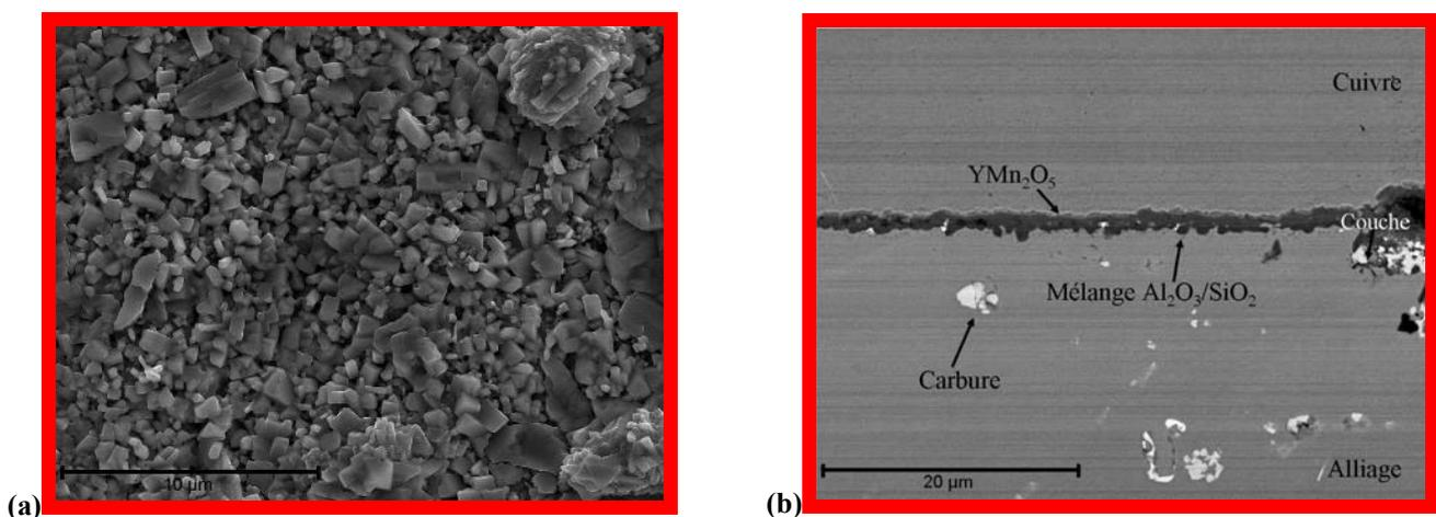
Figure V.14 : Observation MEB de l'alliage Haynes230 revêtu de Y<sub>2</sub>O<sub>3</sub> après oxydation sous air à la pression atmosphérique pendant 320 jours à 800°C. (a) Image en électrons secondaires de la surface. (b) Image en électrons rétrodiffusés d'une coupe transversale.
