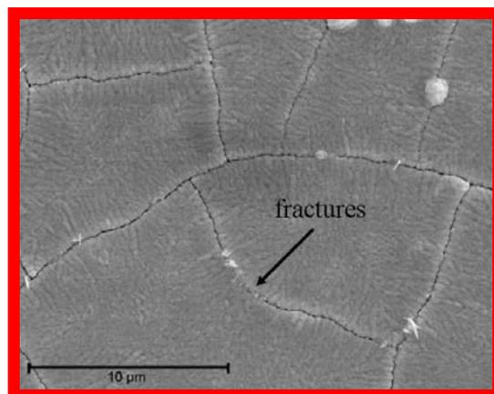
Figure IV.36 : Observation MEB de l'alliage Haynes230 revêtu de  $Y_2O_3$  pré-oxydé après oxydation sous  $H_2/10\%H_2O$  sous 150 mbar pendant 100 h à 800°C.
