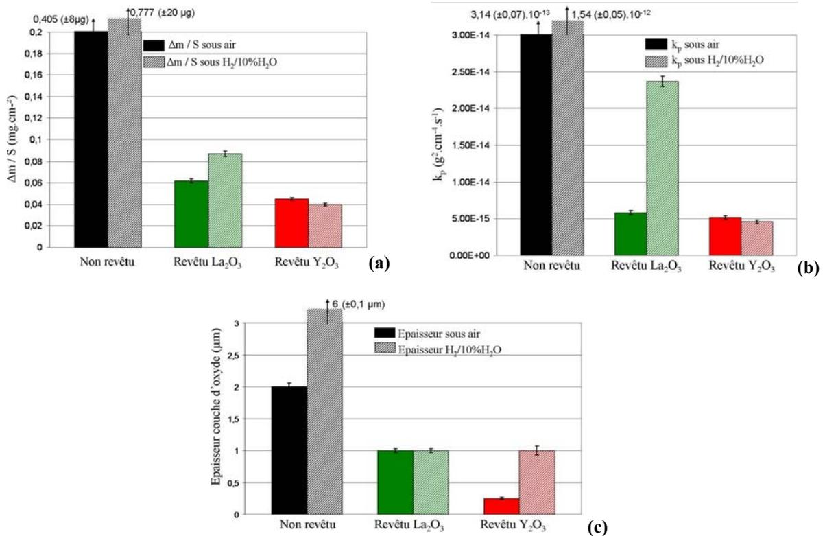
Figure III.28 : Comparaison de  $\Delta m/S$  (a), de  $k_p$  (b) et de l'épaisseur des couches d'oxyde (c) sur l'acier Fe30Cr non revêtu et revêtu de RE<sub>2</sub>O<sub>3</sub> après 100 h sous air et sous H<sub>2</sub>/H<sub>2</sub>O à 800°C
