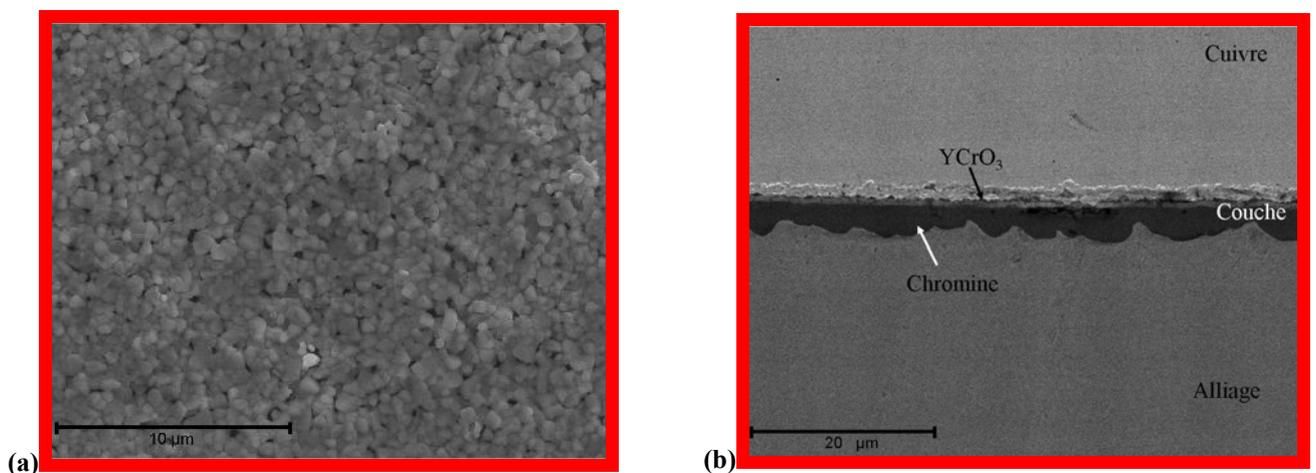
Figure V.26 : Observation MEB de l'acier Fe30Cr revêtu de  $\text{Y}_2\text{O}_3$  après oxydation sous air à la pression atmosphérique pendant 640 jours à 800°C. (a) Image en électrons secondaires de la surface. (b) Image en électrons rétrodiffusés d'une coupe transversale.
