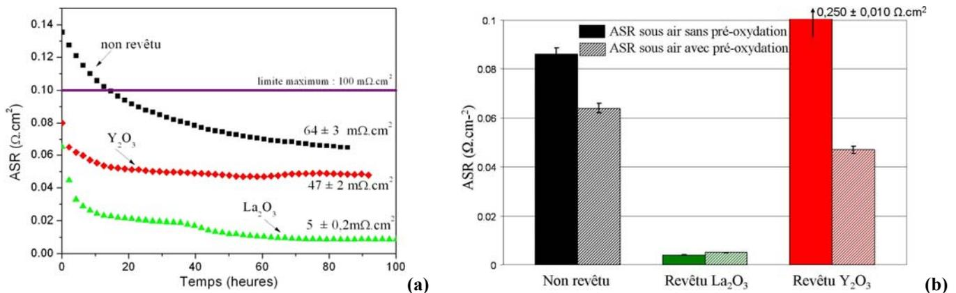
Figure IV.24 : (a) Courbes ASR de l'acier Crofer22APU non revêtu et revêtu de RE<sub>2</sub>O<sub>3</sub> pré-oxydé pendant 100 h à 800°C sous air à la pression atmosphérique. (b) Comparaison du paramètre ASR de l'alliage Crofer22APU non revêtu et revêtu de RE<sub>2</sub>O<sub>3</sub> pré-oxydé ou non.
