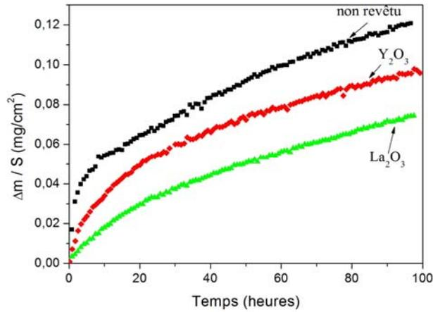
Figure III.24 : Courbes cinétiques des oxydations réalisées sur l'acier Crofer22APU non revêtu et revêtu de  $RE_2O_3$  oxydé 100 h à 800°C sous  $H_2/10\%H_2O$  sous 150 mbar
