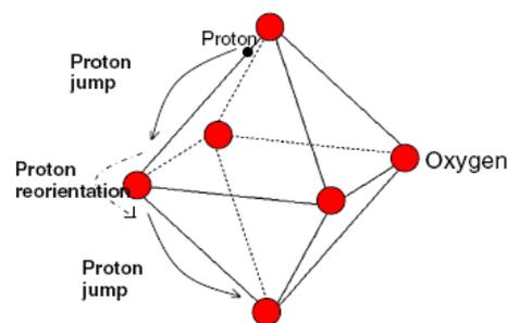
Figure I.23 : Illustration du mécanisme de grotthuss [175]
