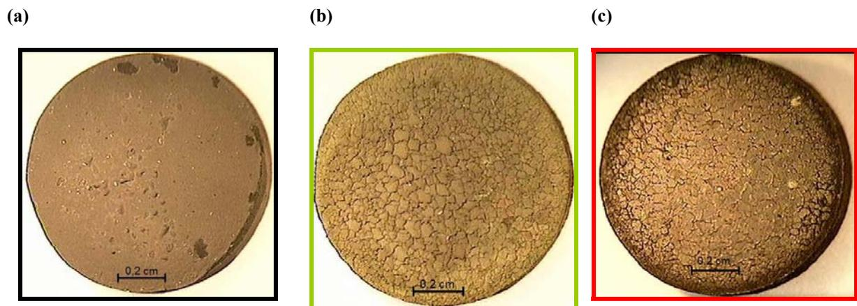
Figure V.33 : Observations macroscopiques de l'acier Fe30Cr non revêtu (a), revêtu de  $\text{La}_2\text{O}_3$  (b) et revêtu de  $\text{Y}_2\text{O}_3$  (c) pré-oxydés après 320 jours d'oxydation sous air à  $800^\circ\text{C}$ .
