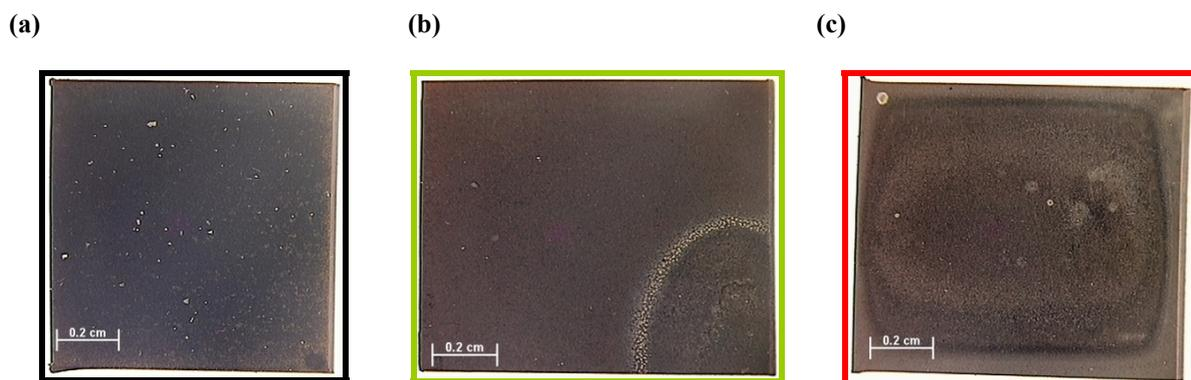
Figure V.3 : Observation macroscopique de l'alliage Haynes230 non revêtu (a), revêtu de  $\text{La}_2\text{O}_3$  (b) et revêtu de  $\text{Y}_2\text{O}_3$  (c) après 320 jours d'oxydation sous air à la pression atmosphérique à  $800^\circ\text{C}$ .
