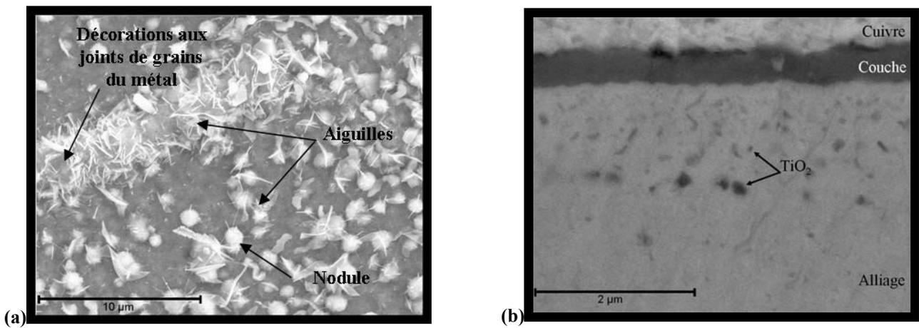
Figure III.30 : Observation MEB de l'acier Crofer22APU non revêtu après oxydation sous H<sub>2</sub>/10%H<sub>2</sub>O sous 150 mbar pendant 100 h à 800°C. (a) Image en électrons secondaires de la surface. (b) Image en électrons rétrodiffusés d'une coupe transversale.
