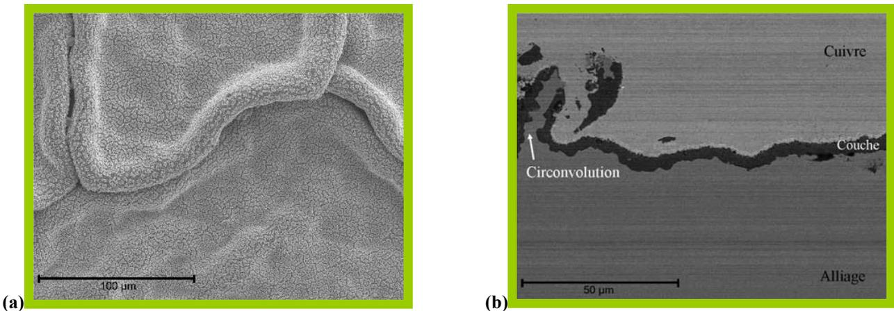
Figure V.39 : Observation MEB de l'acier Fe30Cr revêtu de  $\text{La}_2\text{O}_3$  pré-oxdé après oxydation sous air à la pression atmosphérique pendant 320 jours à 800°C. (a) Image en électrons secondaires de la surface. (b) Image en électrons rétrodiffusés d'une coupe transversale.
