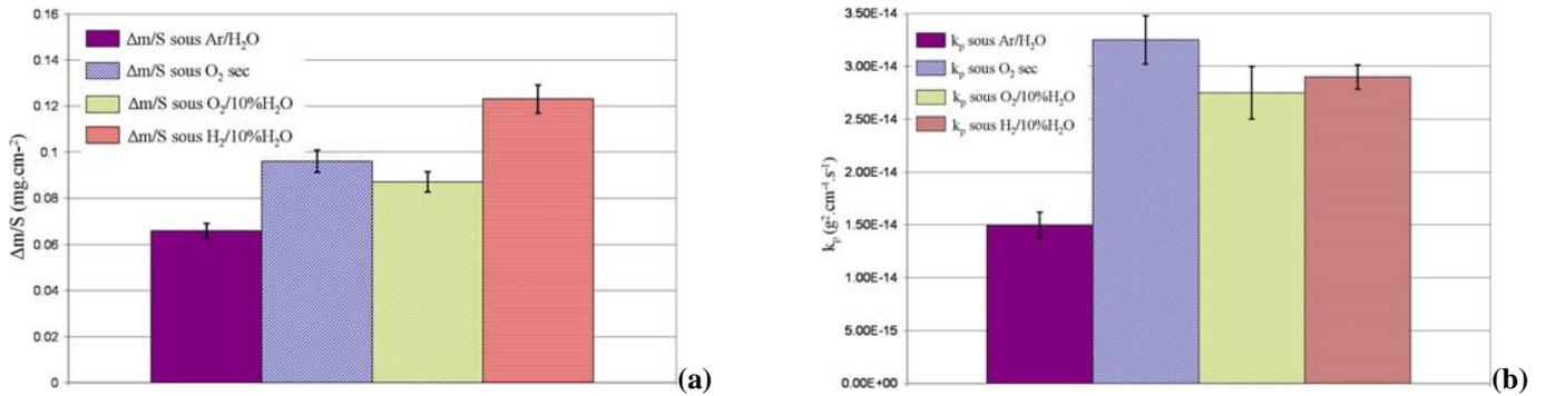
Figure VI.7 : Comparaison de  $\Delta m/S$  (a) et de  $k_p$  (b) sur l'acier Crofer22APU non revêtu oxydé pendant 100h à 800°C sous Ar/10%H<sub>2</sub>O, O<sub>2</sub> sec, O<sub>2</sub>/10%H<sub>2</sub>O et sous H<sub>2</sub>/10%H<sub>2</sub>O sous 150 mbar
