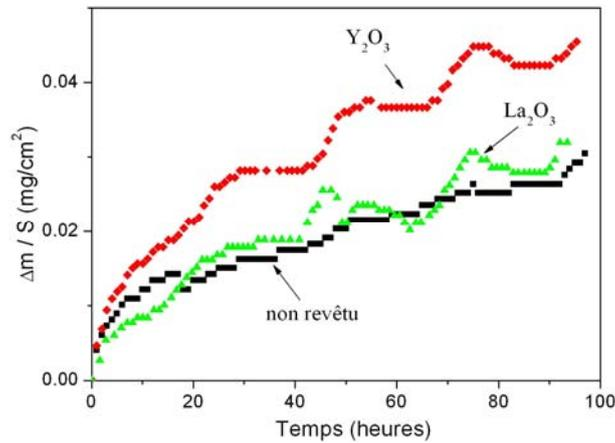
Figure III.3: Courbes cinétiques de l'alliage Haynes230 non revêtu et revêtu de  $RE_2O_3$  oxydé 100 h à  $800^\circ C$  sous air à la pression atmosphérique
