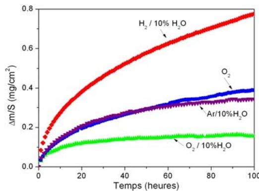
Figure VI.8 : Courbes cinétiques des oxydations réalisées sur l'acier Fe30Cr non revêtu pendant 100 h à 800°C sous Ar/10%H<sub>2</sub>O, O<sub>2</sub> sec, O<sub>2</sub>/10%H<sub>2</sub>O et sous H<sub>2</sub>/10%H<sub>2</sub>O sous 150 mbar
