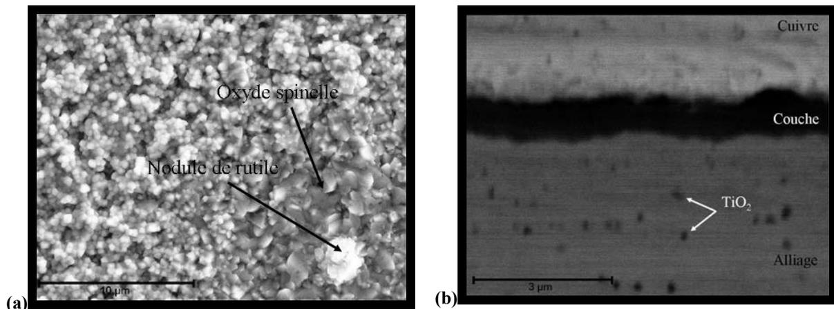
**Figure IV.2 :** Observation MEB de l'alliage Crofer22APU non revêtu après 2 h de pré-oxydation à 1000°C sous air à la pression atmosphérique. (a) Image en électrons secondaires de la surface. (b) Image en électrons rétrodiffusés d'une coupe transversale.
