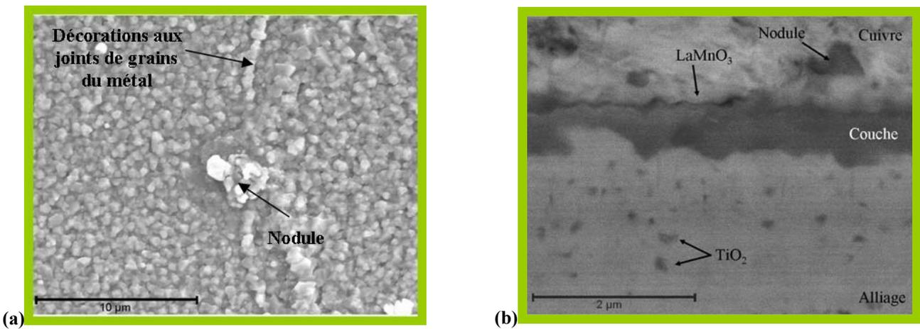
Figure III.31 : Observation MEB de l'acier Crofer22APU revêtu de La<sub>2</sub>O<sub>3</sub> après oxydation sous H<sub>2</sub>/10%H<sub>2</sub>O sous 150 mbar pendant 100 h à 800°C. (a) Image en électrons secondaires de la surface. (b) Image en électrons rétrodiffusés d'une coupe transversale.
