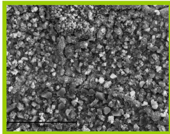
Figure IV.35 : Observation MEB de l'alliage Haynes230 revêtu de  $La_2O_3$  pré-oxydé après oxydation sous  $H_2/10\%H_2O$  sous 150 mbar pendant 100 h à 800°C.
