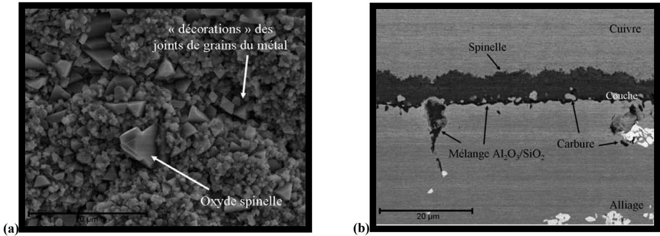
Figure V.12 : Observation MEB de l'alliage Haynes230 non revêtu après oxydation sous air à la pression atmosphérique pendant 320 jours à 800°C. (a) Image en électrons secondaires de la surface. (b) Image en électrons rétrodiffusés d'une coupe transversale.
