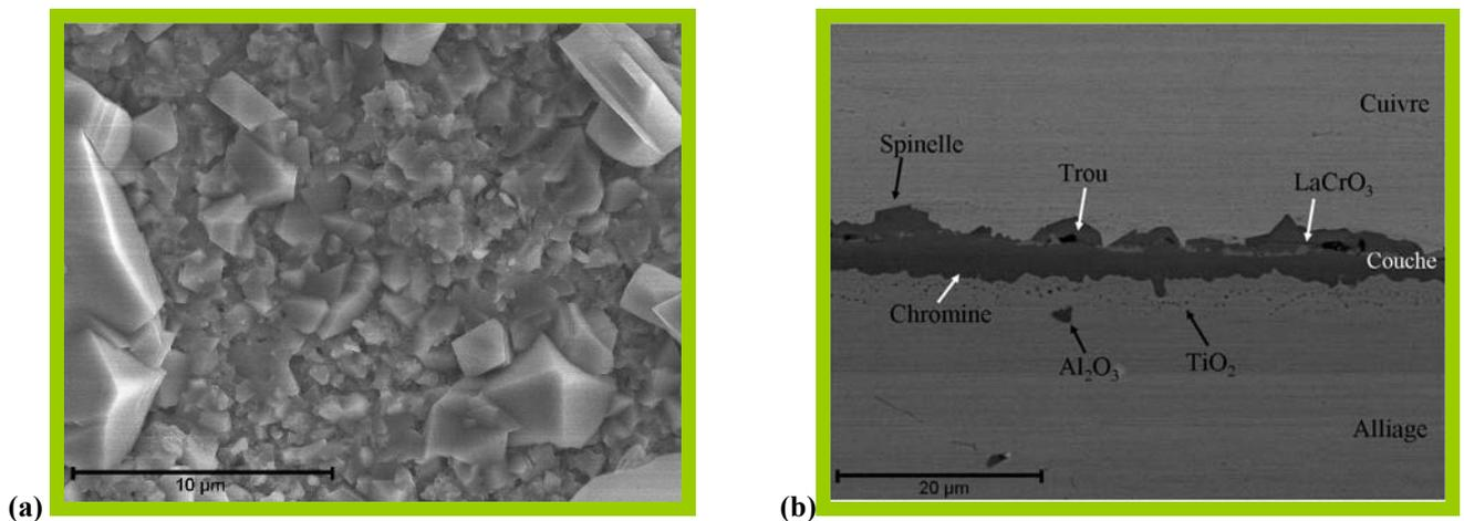
Figure V.6 : Observation MEB de l'acier Crofer22APU revêtu de  $\text{La}_2\text{O}_3$  après oxydation sous air à la pression atmosphérique pendant 320 jours à 800°C. (a) Image en électrons secondaires de la surface. (b) Image en électrons rétrodiffusés d'une coupe transversale.
