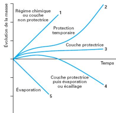
Figure I.7 : Diverses cinétiques de corrosion [41]
