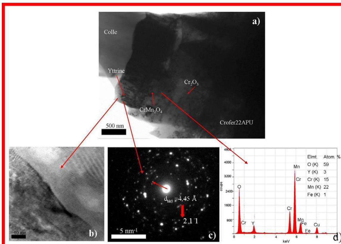
Figure III.19 : Observation MET d'une coupe transverse de l'acier Crofer22APU revêtu de  $Y_2O_3$  après 100 h à 800°C sous air à la pression atmosphérique ; (a) image en champ clair ; (b) détail de la couche d'yttrine ; (c) cliché de diffraction de la couche d'yttrine ; (d) spectre EDX de la couche de spinelle
