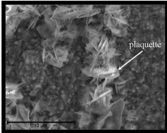
Figure IV.28 : Observation MEB de l'acier Crofer22APU non revêtu pré-oxydé après oxydation sous  $H_2/10\%H_2O$  sous 150 mbar pendant 100 h à 800°C.
