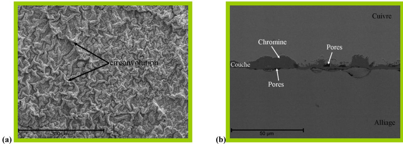
Figure V.10 : Observation MEB de l'acier Fe30Cr revêtu de La<sub>2</sub>O<sub>3</sub> après oxydation sous air à la pression atmosphérique pendant 320 jours à 800°C. (a) Image en électrons secondaires de la surface. (b) Image en électrons rétrodiffusés d'une coupe transversale.
