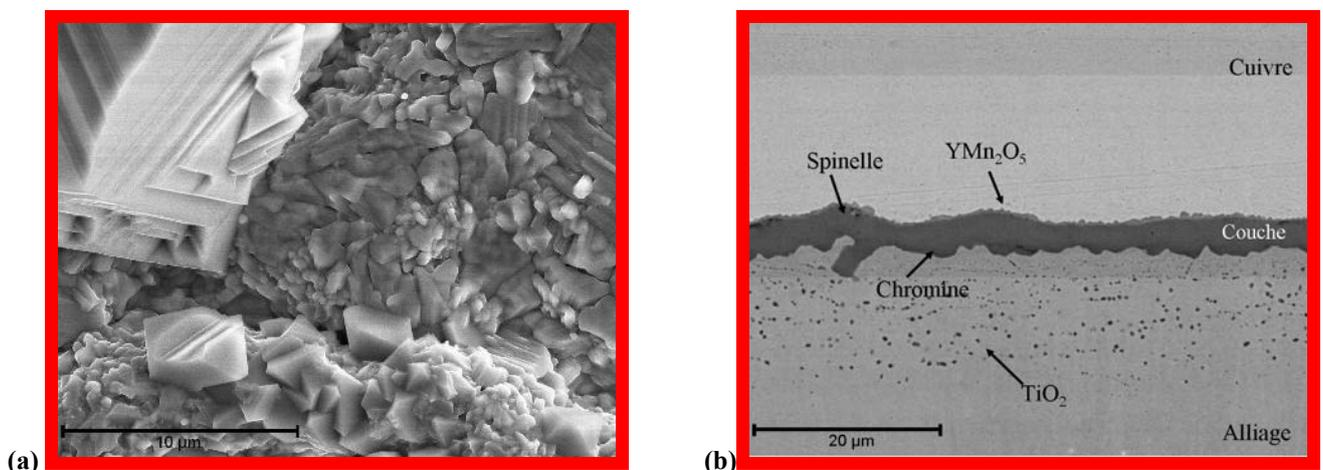
Figure V.7 : Observation MEB de l'acier Crofer22APU revêtu de  $\text{Y}_2\text{O}_3$  après oxydation sous air à la pression atmosphérique pendant 320 jours à 800°C. (a) Image en électrons secondaires de la surface. (b) Image en électrons rétrodiffusés d'une coupe transversale.
