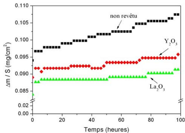
Figure IV.9 : courbes cinétiques des oxydations réalisées sur l'alliage Haynes230 non revêtu et revêtu de RE<sub>2</sub>O<sub>3</sub> pré-oxylé puis oxydé 100 h à 800°C sous air à la pression atmosphérique
