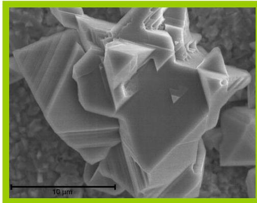
Figure V.8 : Détail d'un grain d'oxyde spinelle à la surface de l'acier Crofer22APU revêtu de  $\text{La}_2\text{O}_3$  oxydé 320 jours sous air à la pression atmosphérique à 800°C
