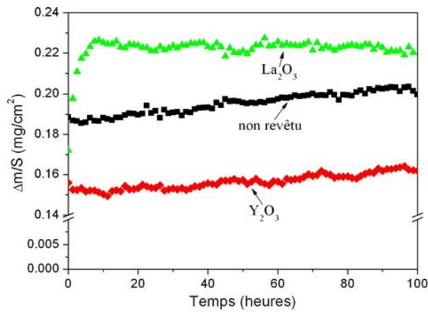
Figure IV.25 : Courbes cinétiques des oxydations réalisées sur l'acier Crofer22APU non revêtu et revêtu de  $RE_2O_3$  pré-oxydé puis oxydé 100 heures à 800°C sous  $H_2/10\%H_2O$  sous 150 mbar
