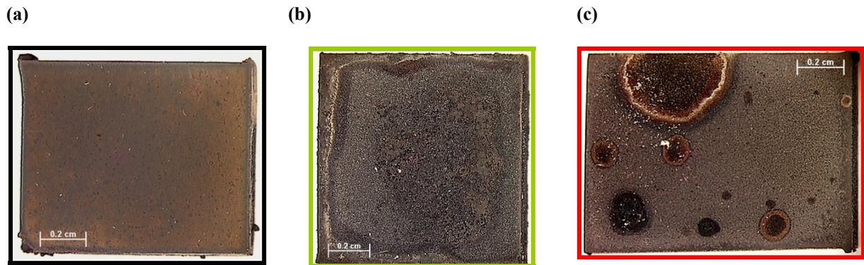
Figure V.1 : Observation macroscopique de l'alliage Crofer22APU non revêtu (a), revêtu de  $\text{La}_2\text{O}_3$  (b) et revêtu de  $\text{Y}_2\text{O}_3$  (c) après 320 jours d'oxydation sous air à la pression atmosphérique à  $800^\circ\text{C}$ .
