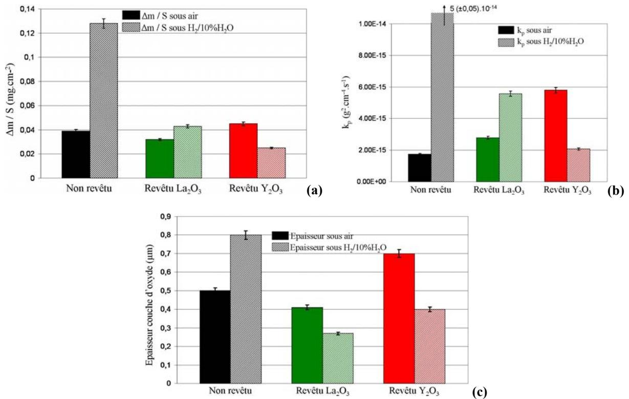
Figure III.29 : Comparaison de  $\Delta m/S$  (a), de  $k_p$  (b) et de l'épaisseur des couches d'oxyde (c) sur l'alliage Haynes230 non revêtu et revêtu RE<sub>2</sub>O<sub>3</sub> de après 100 h sous air et sous H<sub>2</sub>/H<sub>2</sub>O à 800°C
