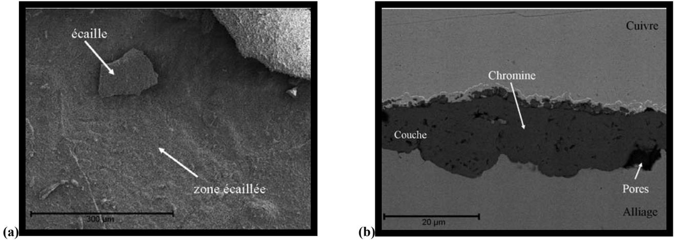
Figure V.24 : Observation MEB de l'acier Fe30Cr non revêtu après oxydation sous air à la pression atmosphérique pendant 640 jours à 800°C. (a) Image en électrons secondaires de la surface. (b) Image en électrons rétrodiffusés d'une coupe transversale.
