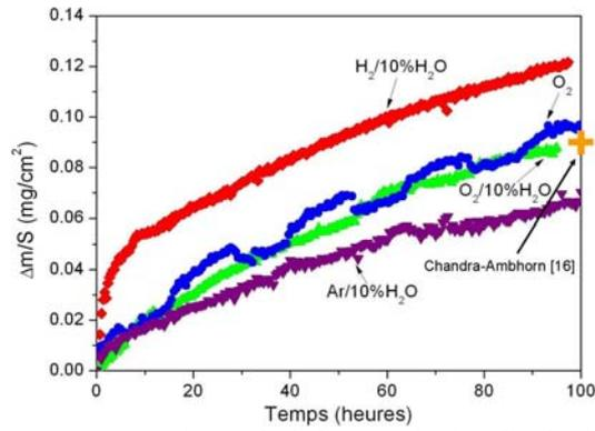
Figure VI.6 : Courbes cinétiques des oxydations réalisées sur l'acier Crofer22APU non revêtu pendant 100 h à 800°C sous Ar/10%H<sub>2</sub>O, O<sub>2</sub> sec, O<sub>2</sub>/10%H<sub>2</sub>O et sous H<sub>2</sub>/10%H<sub>2</sub>O sous 150 mbar. La croix représente le Δm/S obtenu par Chandra-Ambhorn et al. sous air et sous H<sub>2</sub>/2%H<sub>2</sub>O à 800°C [16]
