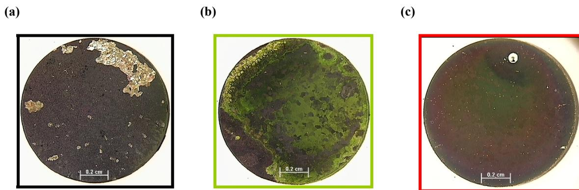
Figure V.2 : Observation macroscopique de l'alliage Fe30Cr non revêtu (a), revêtu de  $\text{La}_2\text{O}_3$  (b) et revêtu de  $\text{Y}_2\text{O}_3$  (c) après 320 jours d'oxydation sous air à la pression atmosphérique à  $800^\circ\text{C}$ .
