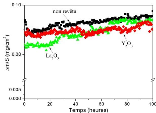
Figure IV.27 : Courbes cinétiques des oxydations réalisées sur l'alliage Haynes230 non revêtu et revêtu de  $RE_2O_3$  pré-oxydé puis oxydé 100 heures à 800°C sous  $H_2/10\%H_2O$  sous 150 mbar
