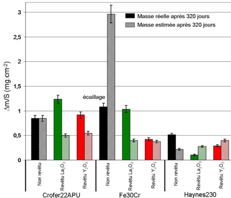
Figure V.4 : Prises de masse réelle et estimée des alliages Crofer22APU, Fe30Cr et Haynes230 revêtus et non revêtus de  $\text{RE}_2\text{O}_3$  après 320 jours sous air à la pression atmosphérique à 800°C
