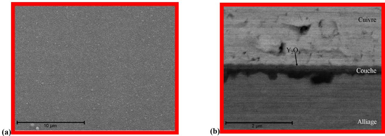
Figure III.10 : Observation MEB de l'acier Fe30Cr revêtu de  $\text{Y}_2\text{O}_3$  après oxydation sous air à la pression atmosphérique pendant 100 h à 800°C. (a) Image en électrons secondaires de la surface. (b) Image en électrons rétrodiffusés d'une coupe transversale.
