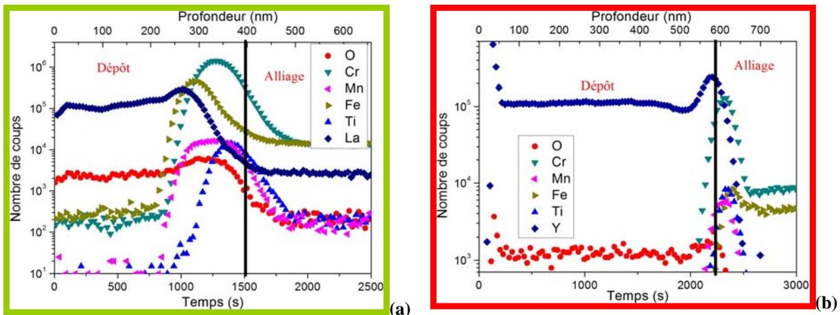
Figure II.1 : Profil de composition réalisé par SIMS sur l'acier Crofer22APU revêtu de  $\text{La}_2\text{O}_3$  (a) et de  $\text{Y}_2\text{O}_3$  (b)
