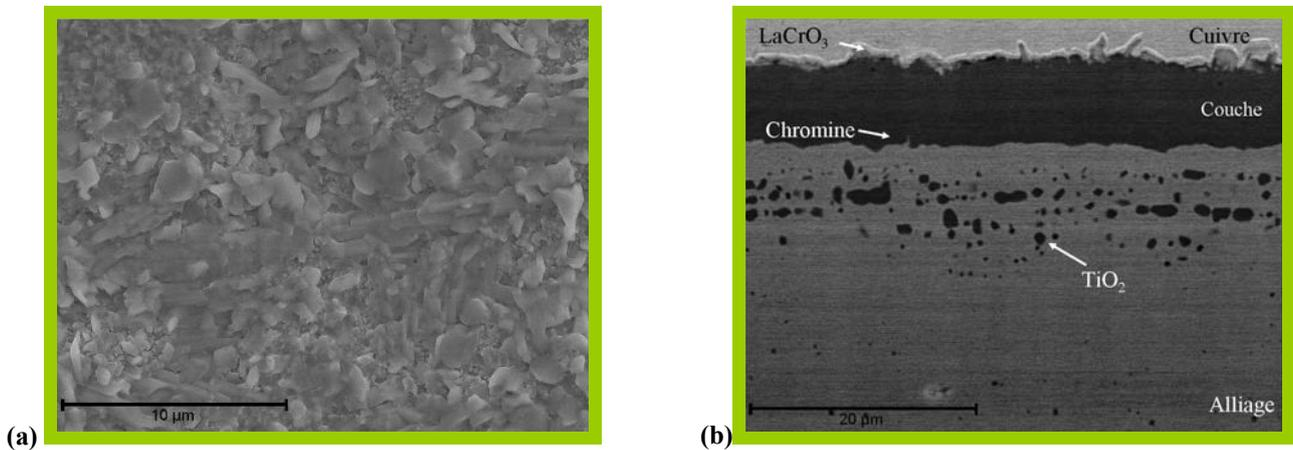
Figure V.36 : Observation MEB de l'acier Crofer22APU revêtu de  $\text{La}_2\text{O}_3$  pré-oxidé après oxydation sous air à la pression atmosphérique pendant 320 jours à 800°C. (a) Image en électrons secondaires de la surface. (b) Image en électrons rétrodiffusés d'une coupe transversale.
