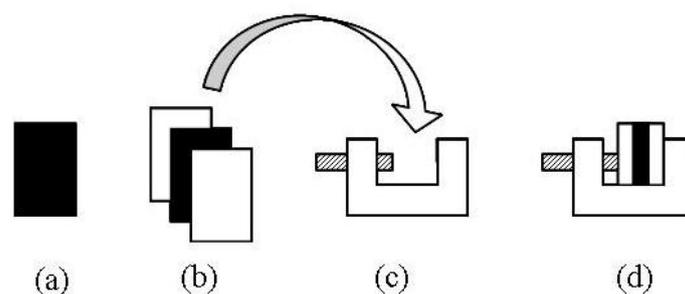
Figure II.3 : Préparation des coupes transversales pour MEB
