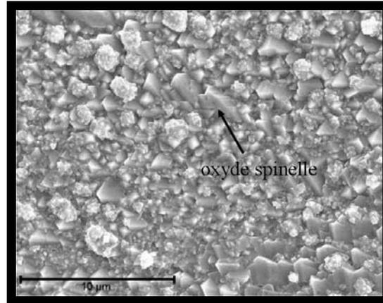
**Figure IV.19 :** Observation MEB de l'alliage Haynes230 non revêtu pré-oxdé après oxydation sous air à la pression atmosphérique pendant 100 h à 800°C.
