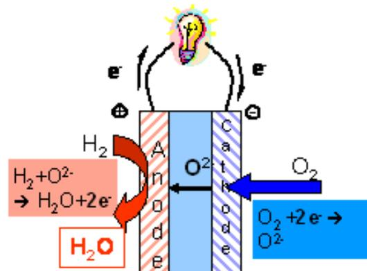
Figure I.2 : Principe de fonctionnement d'une pile SOFC
