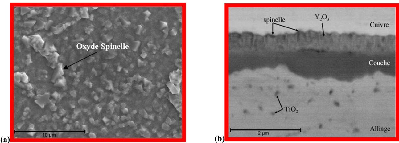
Figure III.32 : Observation MEB de l'acier Crofer22APU revêtu de Y<sub>2</sub>O<sub>3</sub> après oxydation sous H<sub>2</sub>/10%H<sub>2</sub>O sous 150 mbar pendant 100 h à 800°C. (a) Image en électrons secondaires de la surface. (b) Image en électrons rétrodiffusés d'une coupe transversale.
