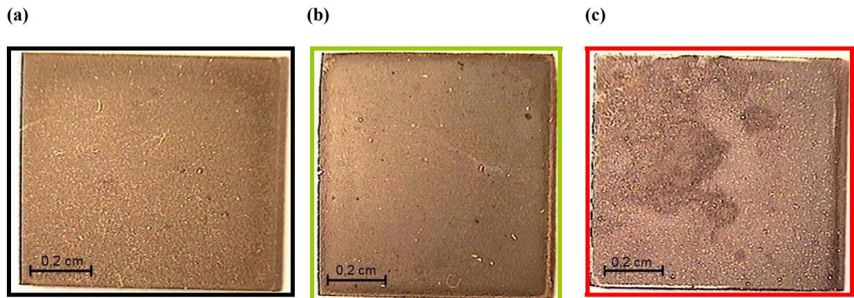
Figure V.32 : Observations macroscopiques de l'acier Crofer22APU non revêtu (a), revêtu de  $\text{La}_2\text{O}_3$  (b) et revêtu de  $\text{Y}_2\text{O}_3$  (c) pré-oxydés après 320 jours d'oxydation sous air à  $800^\circ\text{C}$ .
