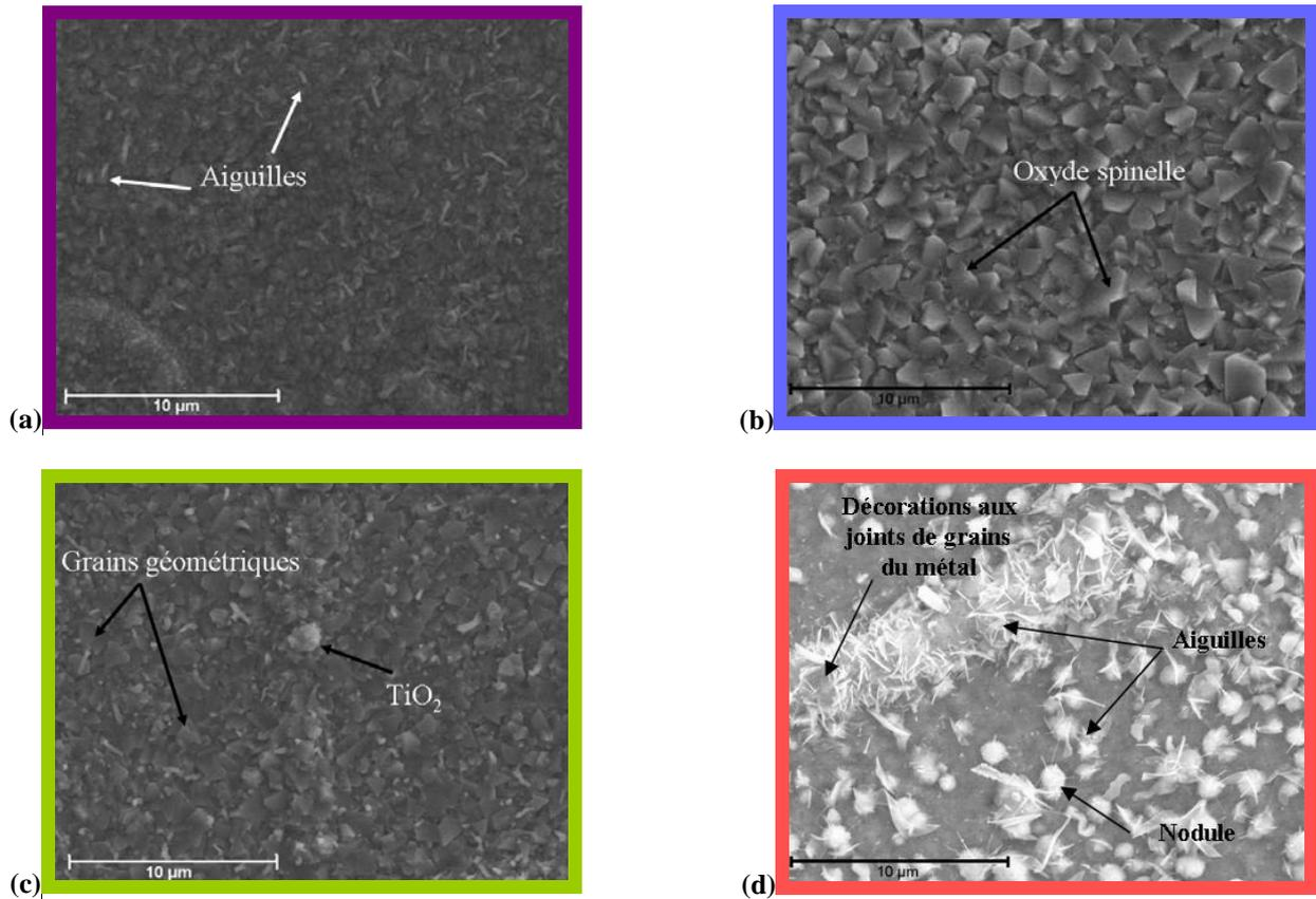
Figure VI.12 : Observation MEB de l'acier Fe30Cr non revêtu oxydé pendant 100 h à 800°C sous (a) Ar/10%H<sub>2</sub>O, (b) O<sub>2</sub> sec, (c) O<sub>2</sub>/10%H<sub>2</sub>O et sous (d) H<sub>2</sub>/10%H<sub>2</sub>O sous 150 mbar
