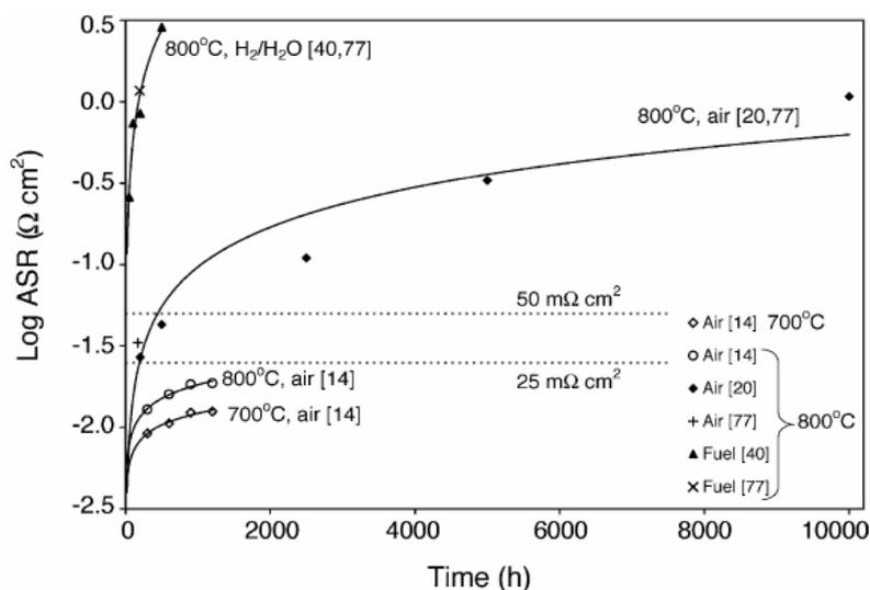
Figure I.20 : Evolution du paramètre ASR de l'alliage Haynes230 [24]
