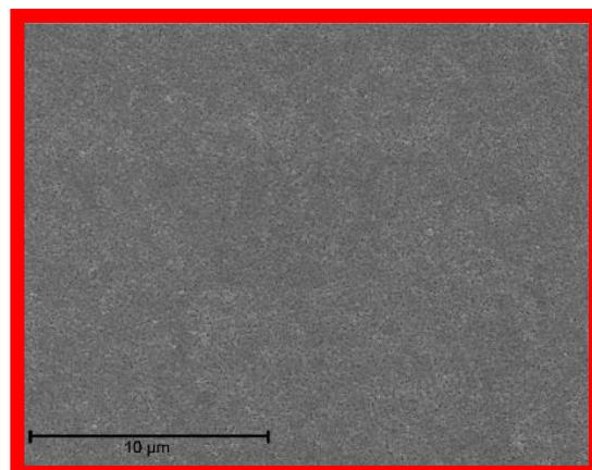
Figure IV.18 : Observation MEB de l'acier Fe30Cr revêtu de  $\text{Y}_2\text{O}_3$  pré-oxydé après oxydation sous air à la pression atmosphérique pendant 100 h à 800°C.
