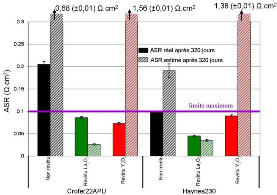
Figure V.16 : Paramètre ASR réel et estimé des alliages Crofer22APU et Haynes230 non revêtus et revêtus de  $\text{RE}_2\text{O}_3$  après 320 jours sous air à la pression atmosphérique à  $800^\circ\text{C}$
