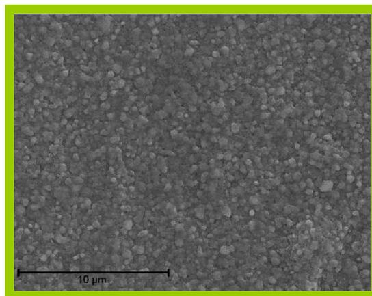
Figure IV.16 : Observation MEB de l'acier Fe30Cr revêtu de  $\text{La}_2\text{O}_3$  pré-oxydé après oxydation sous air à la pression atmosphérique pendant 100 h à 800°C.
