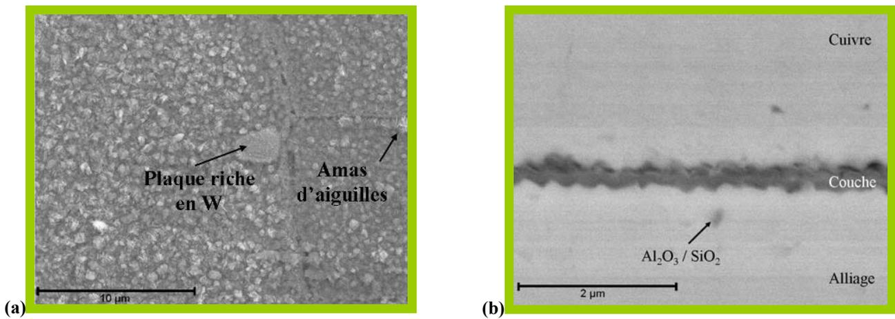
Figure III.37 : Observation MEB de l'alliage Haynes230 revêtu de  $La_2O_3$  après oxydation sous  $H_2/10\%H_2O$  sous 150 mbar pendant 100 h à 800°C. (a) Image en électrons secondaires de la surface. (b) Image en électrons rétrodiffusés d'une coupe transversale.
