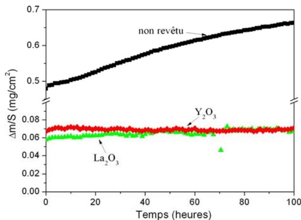
Figure IV.26 : Courbes cinétiques des oxydations réalisées sur l'acier Fe30Cr non revêtu et revêtu de  $RE_2O_3$  pré-oxydé puis oxydé 100 heures à 800°C sous  $H_2/10\%H_2O$  sous 150 mbar
