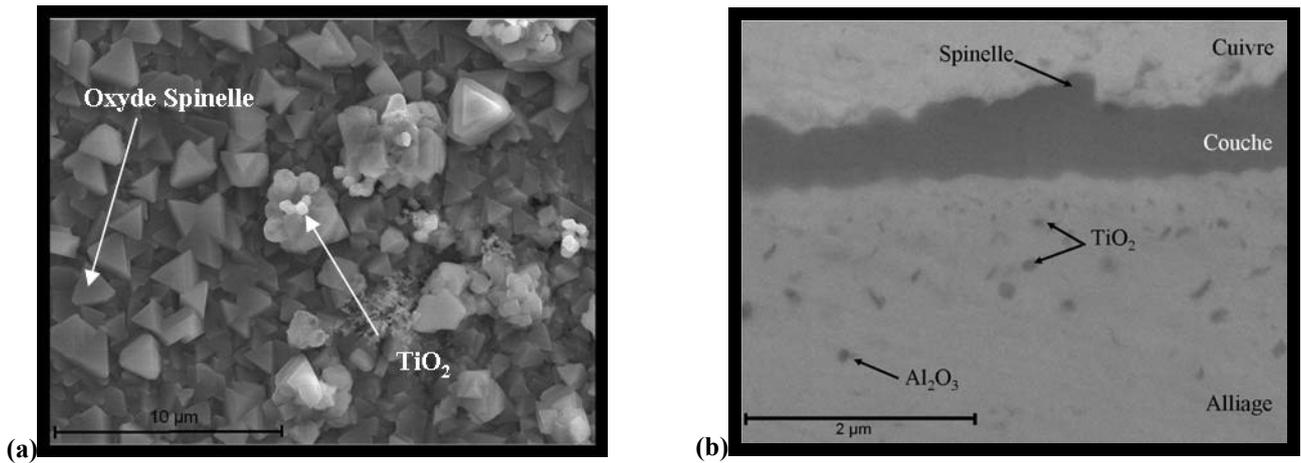
Figure III.4 : Observation MEB de l'acier Crofer22APU non revêtu après oxydation sous air à la pression atmosphérique pendant 100 h à 800°C. (a) Image en électrons secondaires de la surface. (b) Image en électrons rétrodiffusés d'une coupe transversale.
