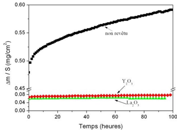
Figure IV.8 : courbes cinétiques des oxydations réalisées sur l'alliage Fe30Cr non revêtu et revêtu de RE<sub>2</sub>O<sub>3</sub> pré-oxylé puis oxydé 100 h à 800°C sous air à la pression atmosphérique
