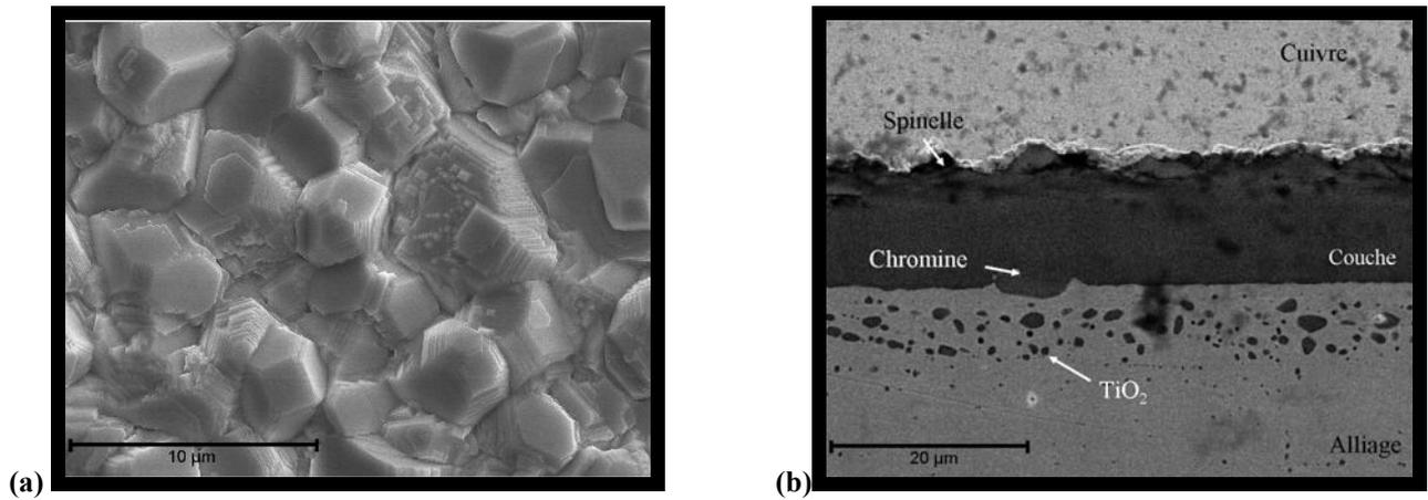
Figure V.35 : Observation MEB de l'acier Crofer22APU non revêtu pré-oxidé après oxydation sous air à la pression atmosphérique pendant 320 jours à 800°C. (a) Image en électrons secondaires de la surface. (b) Image en électrons rétrodiffusés d'une coupe transversale.
