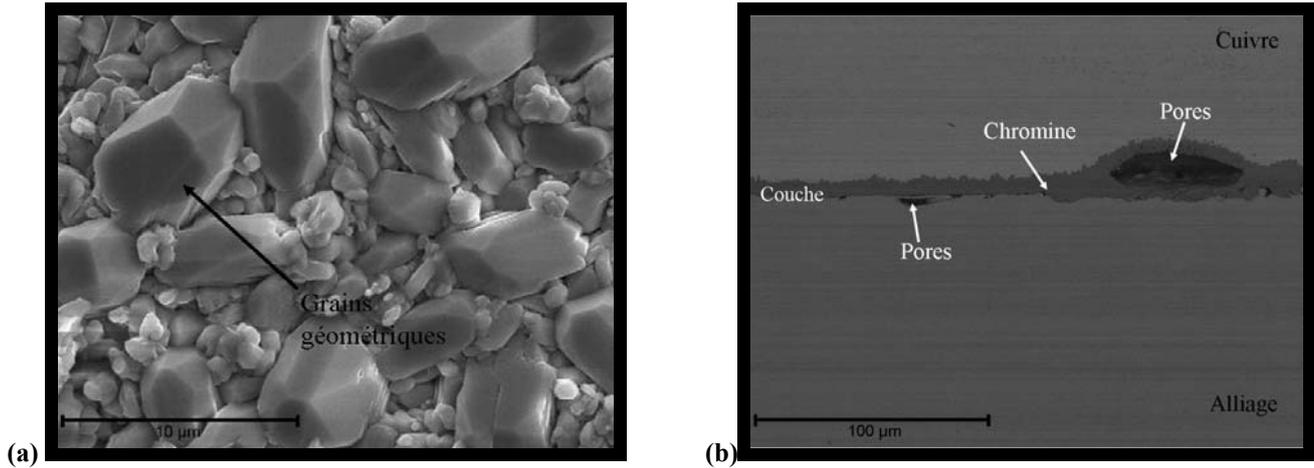
Figure V.9 : Observation MEB de l'acier Fe30Cr non revêtu après oxydation sous air à la pression atmosphérique pendant 320 jours à 800°C. (a) Image en électrons secondaires de la surface. (b) Image en électrons rétrodiffusés d'une coupe transversale.
