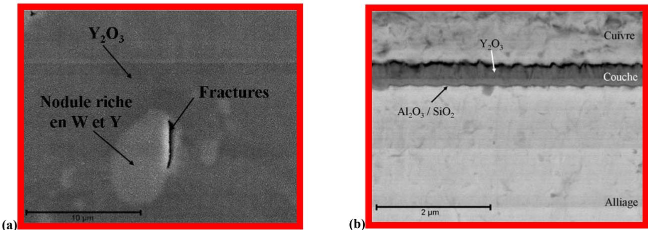
Figure III.38 : Observation MEB de l'alliage Haynes230 revêtu de  $Y_2O_3$  après oxydation sous  $H_2/10\%H_2O$  sous 150 mbar pendant 100 h à 800°C. (a) Image en électrons secondaires de la surface. (b) Image en électrons rétrodiffusés d'une coupe transversale.
