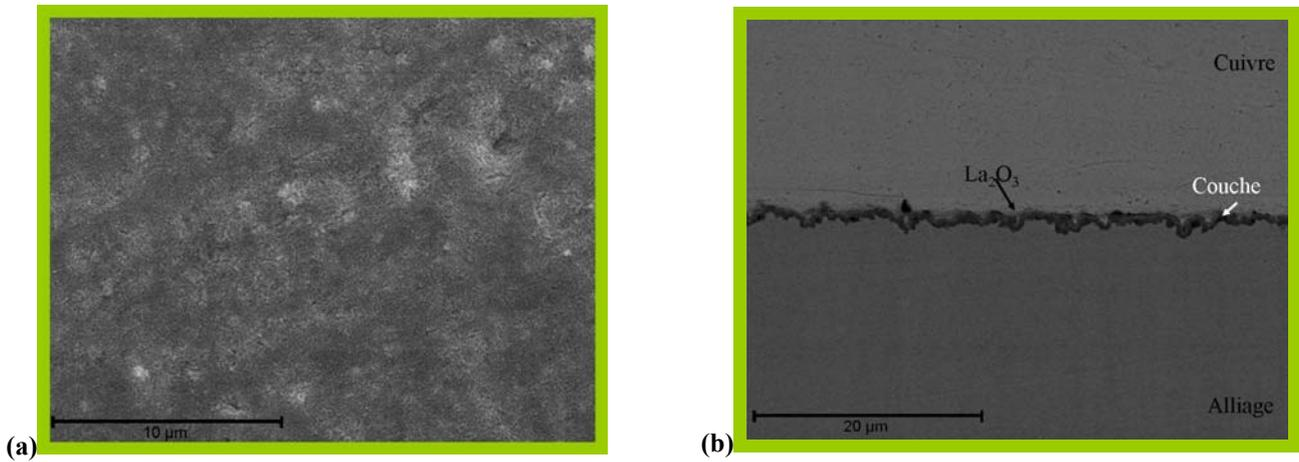
Figure III.34 : Observation MEB de l'acier Fe30Cr revêtu de  $La_2O_3$  après oxydation sous  $H_2/10\%H_2O$  sous 150 mbar pendant 100 h à 800°C. (a) Image en électrons secondaires de la surface. (b) Image en électrons rétrodiffusés d'une coupe transversale.
