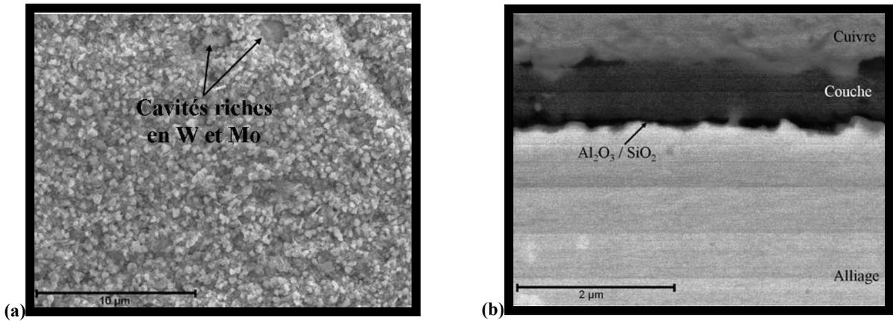
Figure III.36 : Observation MEB de l'alliage Haynes230 non revêtu après oxydation sous  $H_2/10\%H_2O$  sous 150 mbar pendant 100 h à 800°C. (a) Image en électrons secondaires de la surface. (b) Image en électrons rétrodiffusés d'une coupe transversale.
