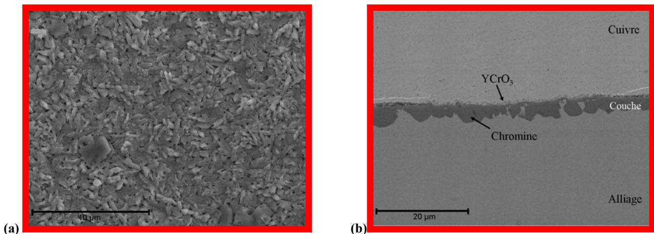
Figure V.11 : Observation MEB de l'acier Fe30Cr revêtu de Y<sub>2</sub>O<sub>3</sub> après oxydation sous air à la pression atmosphérique pendant 320 jours à 800°C. (a) Image en électrons secondaires de la surface. (b) Image en électrons rétrodiffusés d'une coupe transversale.
