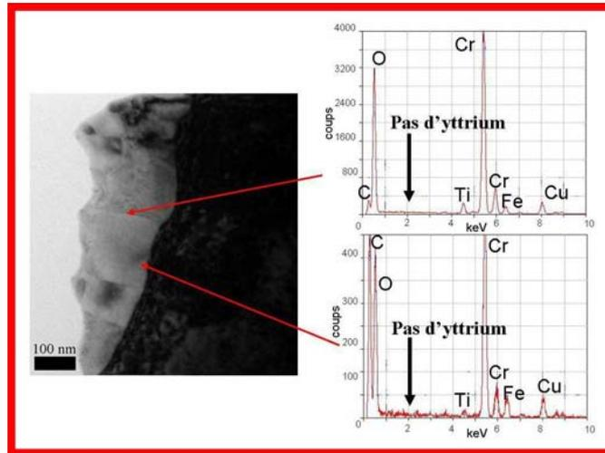
Figure III.20 : Observations MET et microanalyses X de grains et joints de grains de la chromine développés sur l'acier Crofer22APU revêtu de  $Y_2O_3$  après 100 h d'oxydation à 800°C sous air à la pression atmosphérique
