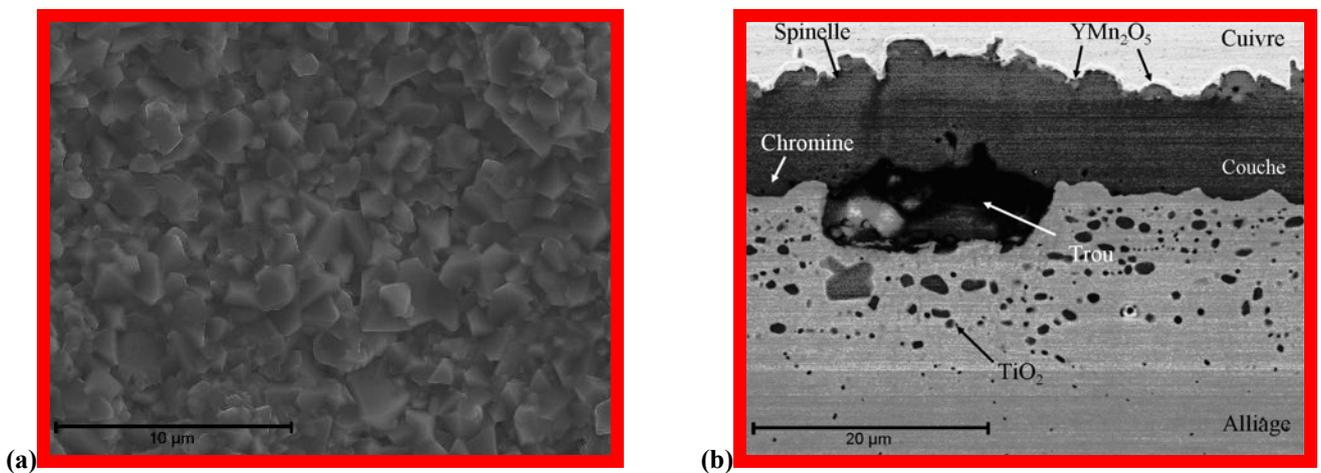
Figure V.23 : Observation MEB de l'acier Crofer22APU revêtu de  $\text{Y}_2\text{O}_3$  après oxydation sous air à la pression atmosphérique pendant 640 jours à 800°C. (a) Image en électrons secondaires de la surface. (b) Image en électrons rétrodiffusés d'une coupe transversale.
