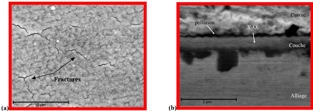
Figure III.35 : Observation MEB de l'acier Fe30Cr revêtu de  $Y_2O_3$  après oxydation sous  $H_2/10\%H_2O$  sous 150 mbar pendant 100 h à 800°C. (a) Image en électrons secondaires de la surface. (b) Image en électrons rétrodiffusés d'une coupe transversale.
