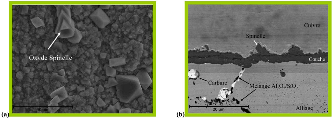
Figure V.28 : Observation MEB de l'alliage Haynes230 revêtu de La<sub>2</sub>O<sub>3</sub> après oxydation sous air à la pression atmosphérique pendant 640 jours à 800°C. (a) Image en électrons secondaires de la surface. (b) Image en électrons rétrodiffusés d'une coupe transversale.
