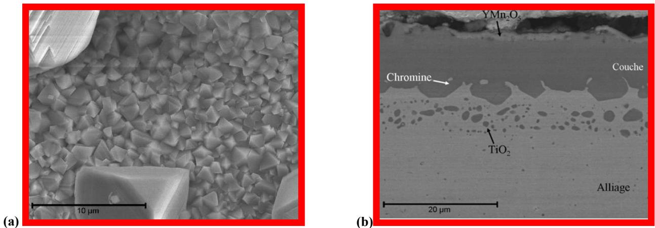
Figure V.37 : Observation MEB de l'acier Crofer22APU revêtu de  $\text{Y}_2\text{O}_3$  pré-oxidé après oxydation sous air à la pression atmosphérique pendant 320 jours à 800°C. (a) Image en électrons secondaires de la surface. (b) Image en électrons rétrodiffusés d'une coupe transversale.
