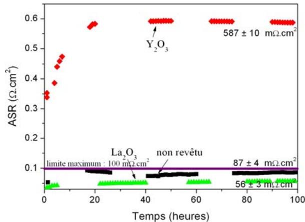
Figure III.22 : Courbes ASR de l'acier Fe30Cr non revêtu et revêtu de RE<sub>2</sub>O<sub>3</sub> pendant 100 h à 800°C sous air à la pression atmosphérique
