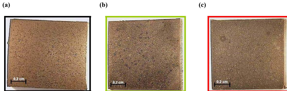
Figure V.17 : Observation macroscopique de l'alliage Crofer22APU non revêtu (a), revêtu de  $\text{La}_2\text{O}_3$  (b) et revêtu de  $\text{Y}_2\text{O}_3$  (c) après 640 jours d'oxydation sous air à la pression atmosphérique à  $800^\circ\text{C}$ .
