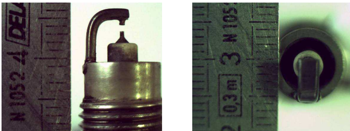
Figure 34 : Caractéristique de la bougie pointe-pointe
