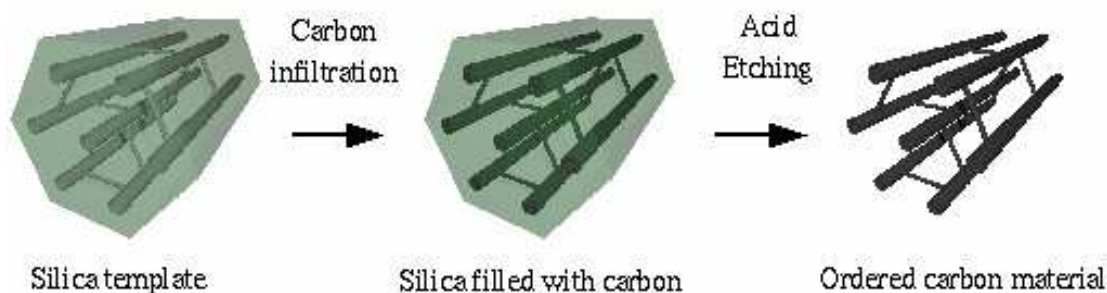
Figure I 11. Principe de la synthèse par réplique négative d'une silice mésoporeuse de type SBA15
