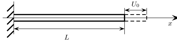
Figure 3.1 : Schématisation du problème de la barre en petits mouvements de traction-compression.
