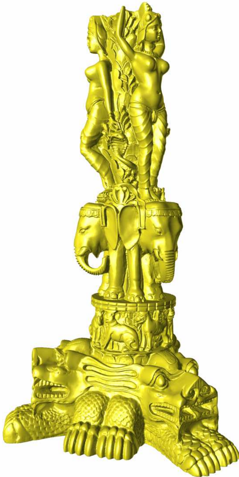
FIG. D.4 – Le maillage simplifié est cette fois composé de 100 mille triangles ( M ) de 170 millions.
