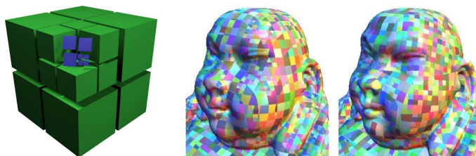
FIG. 7.4 – À gauche la représentation VS-Tree : un octree est utilisé sur les premiers niveaux, les feuilles contenant un quadtree. Le VS-Tree (à droite) présente une meilleure couverture des surfaces que l'octree (au centre).
