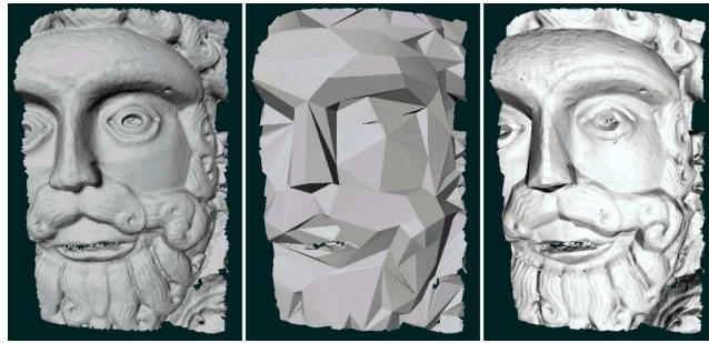
FIG. 2.21 – Préservation d'apparence sur maillage simplifié par la méthode de Cignoni et al. [CMSR98, CMR + 99]. De gauche à droite : maillage original, maillage simplifié, maillage simplifié avec application de texture d'apparence.
