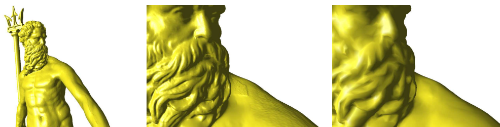
FIG. 2.17 – Les deux captures de gauche montrent le modèle du Neptune, un maillage de 4 millions de polygones. La capture de droite montre une version simplifiée de 100 mille polygones. Si la topologie du maillage est conservée, tous les détails de rugosité du matériau original ont disparus.
