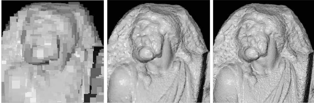
FIG. 6.2 – Transmission progressive de Q-Splats. Les images sont prises à respectivement 1, 10 et 60s sur un réseau de 384 kb/s.
