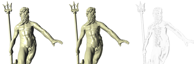
FIG. 4.15 – Gauche : maillage original de 4 millions de triangles. Centre : maillage simplifié de 30 mille polygones. Droite : différence entre les deux images. L’APO utilisée a été construite avec une tolérance de 0.2, la texture est de dimension 4096 \times 2680 .
