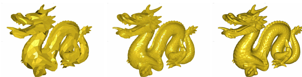
FIG. 1.1 – Plus le nombre de polygones composant un maillage est élevé, plus le maillage comporte de détails. Ici, les objets sont composés respectivement de 3000, 20000 et 800000 triangles.
