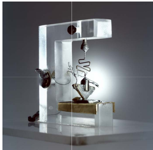
Fig. 1 – Transistor amplificateur « point-contact » construit en 1947 par W. Shockley, J. Bardeen et W. Brattain ( AT&T Bell Laboratories ). Le prix Nobel de Physique leur sera décerné en 1956.
