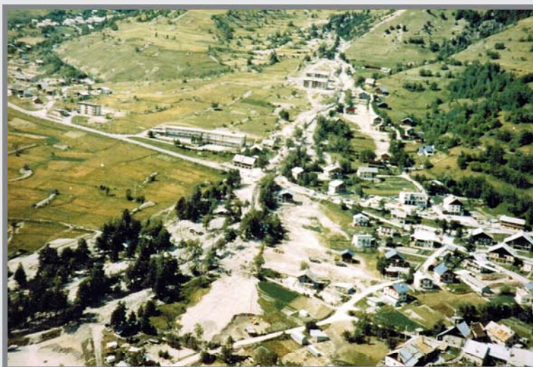
09/07/1981: Vue aérienne oblique sur le cône de déjection du torrent du Verdaire. Les secteurs blanchâtres à proximité du chenal correspondent aux débordements de la lave torrentielle. Source: RTM 05.
