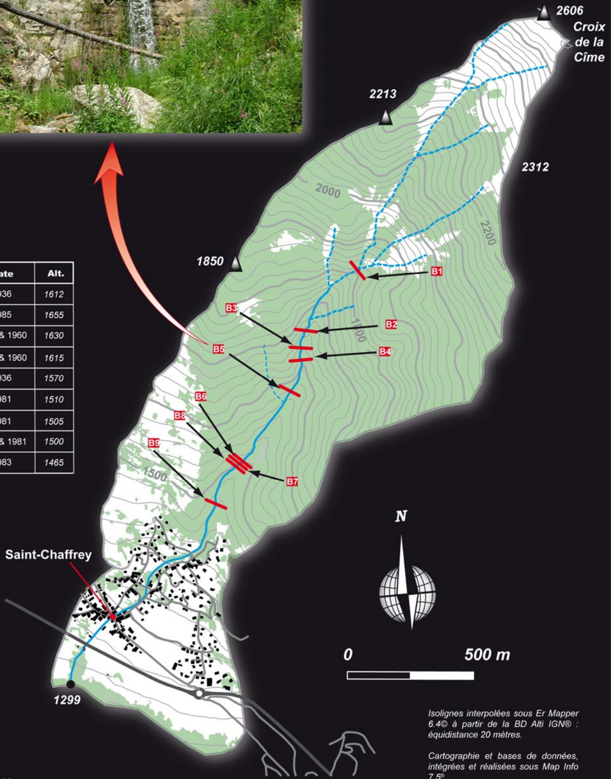
Figure 117 : Cartographie des principaux ouvrages de la correction torrentielle dans le torrent des Sainte-Elisabeth.
