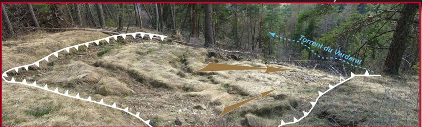
Localisation (GPS) et intégration sous SIG d'un mouvement de terrain dans le bassin versant du Verdarel
