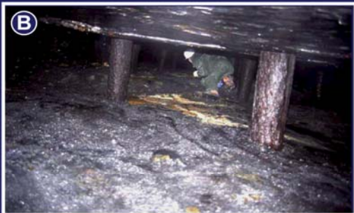
B- Exemple d'une chambre d'extraction. A noter la technique rudimentaire d'étayage en bûches de mélèzes Source: SGMB.
