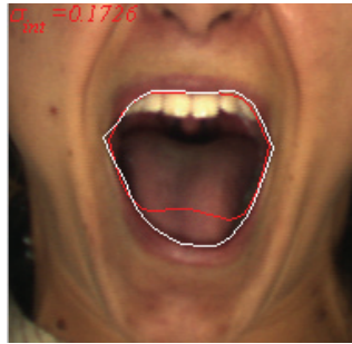
Figure 5.34 : Tracés des contours internes donnés par la vérité-terrain et par notre algorithme. Le tracé rouge correspond à la segmentation automatique et le tracé blanc correspond à la vérité-terrain. On donne également \sigma_{int} .
