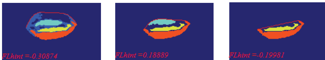
Figure 5.18 : Elimination successive des blobs situés dans la partie supérieure de la bouche et tracés des parties supérieures des polygones convexes entourant les blobs restants.
