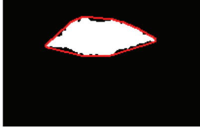
Figure 2.14 : Tracé du plus petit polygone convexe englobant le masque candidat des lèvres de la figure 2.13-e.
