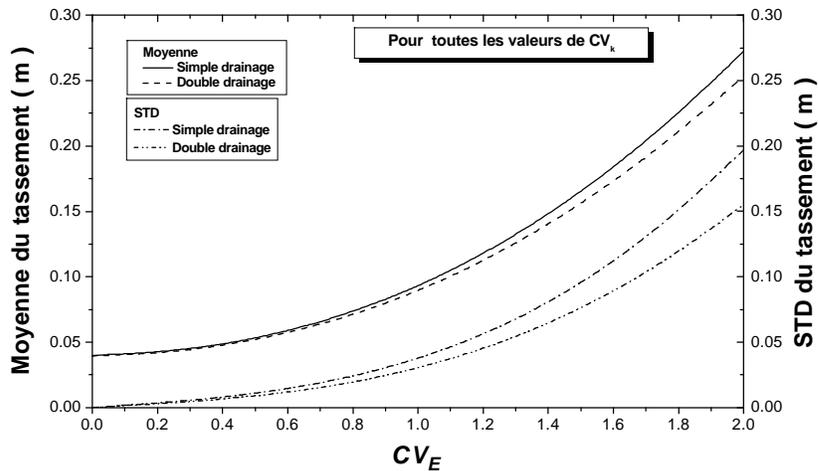
Figure 3.9: Comparaison des variabilités du tassement final.
