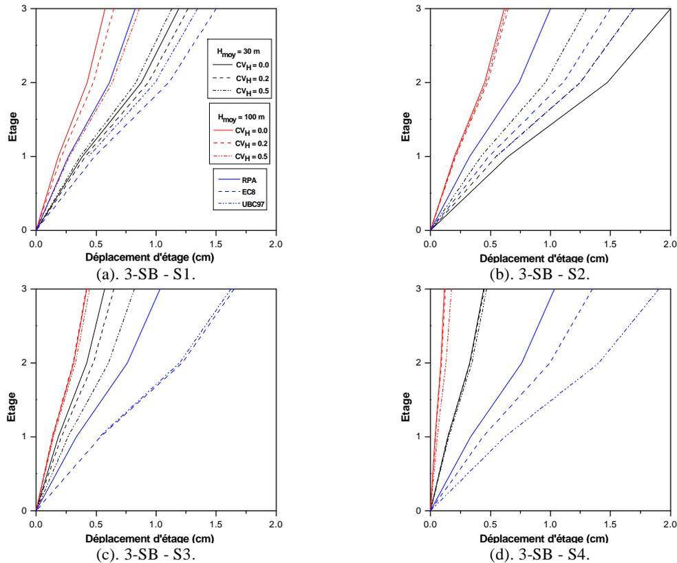
Figure 6.10: Déplacements latéraux d'étages du bâtiment à 3 étages.
