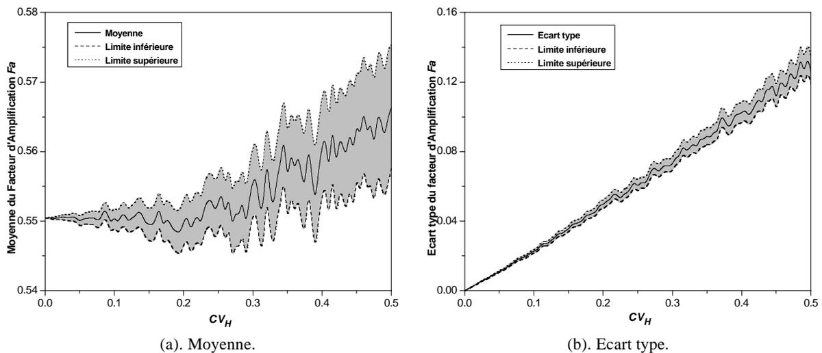
Figure 5.11: Statistiques du facteur d'amplification ( $F_a$ ).
