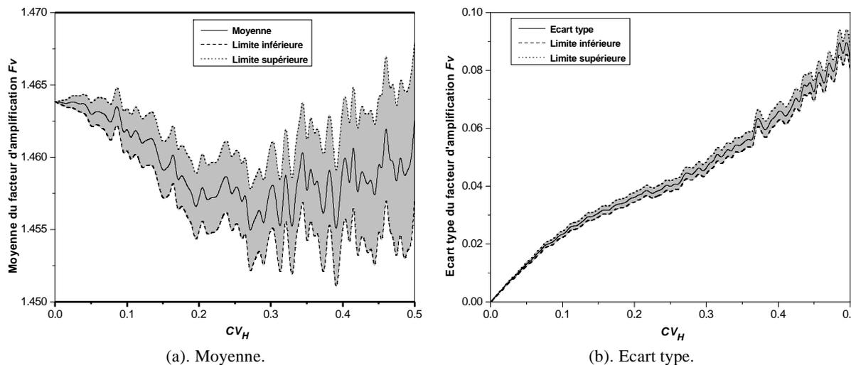
Figure 5.12: Statistiques du facteur d'amplification ( $F_v$ ).
