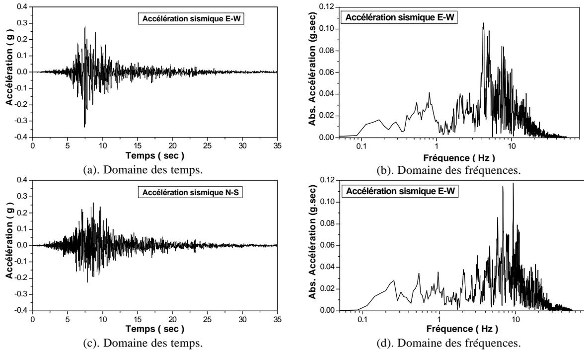
Figure 5.2: Accélération sismique.
