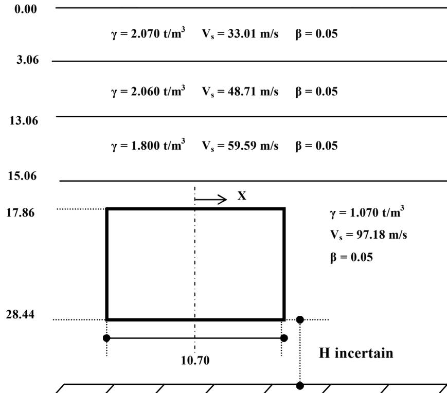
Figure 5.14 : Propriétés du sol et du tunnel.
