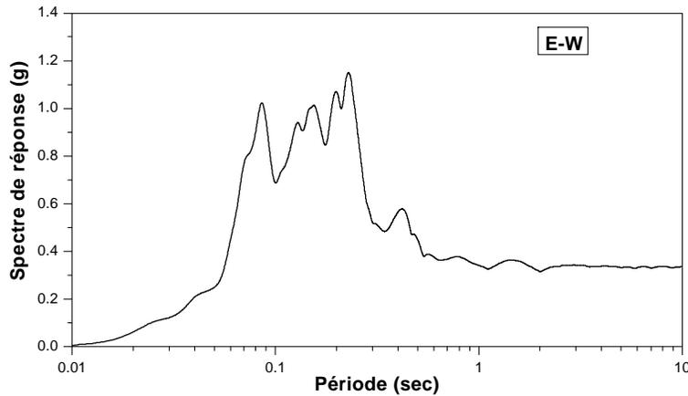
Figure 5.16 : Spectre de réponse de l'accélération sismique d'entrée.
