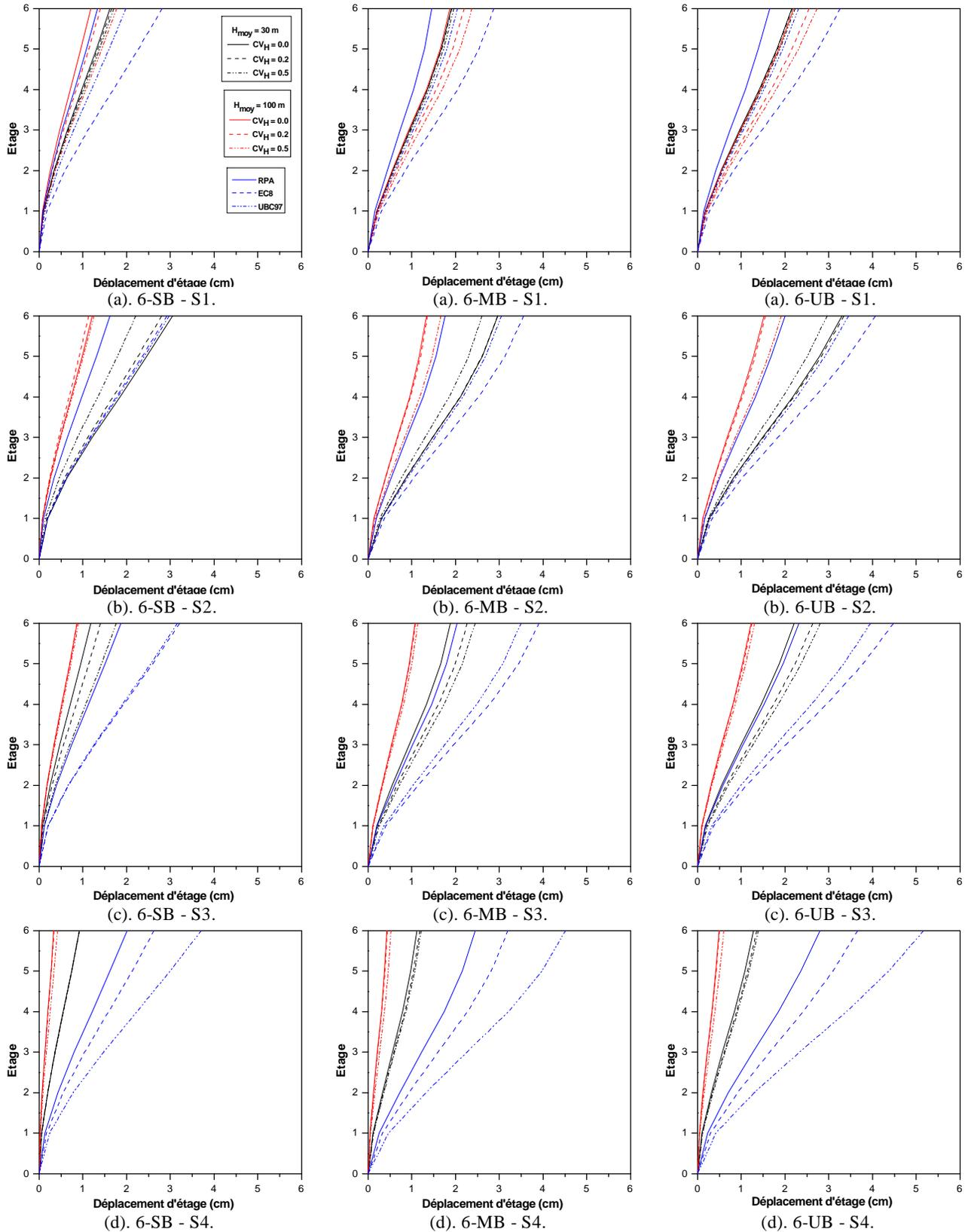
Figure 6.11: Déplacements latéraux d'étages des bâtiments à 6 étages.
