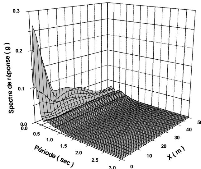
Figure 5.24 : Spectre de réponse de l'accélération en surface.
