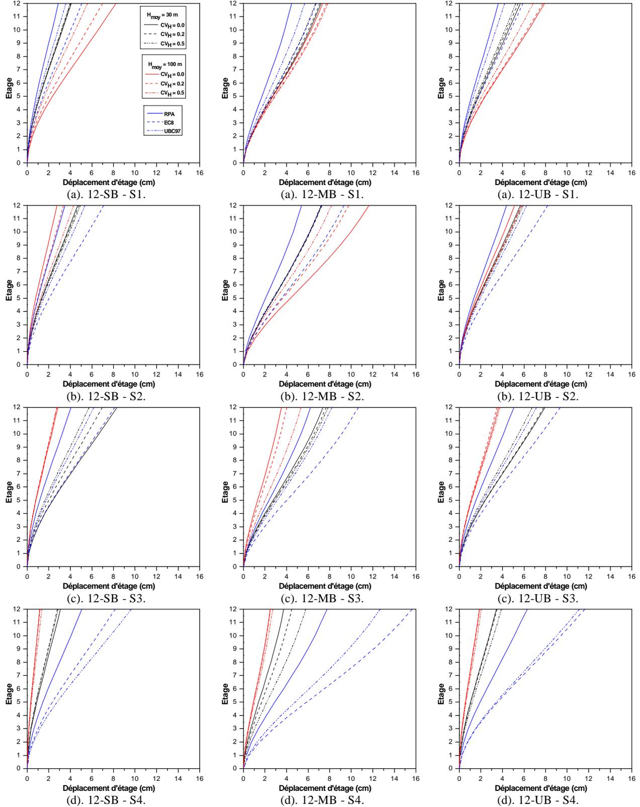
Figure 6.12: Déplacements latéraux d'étages des bâtiments à 12 étages.
