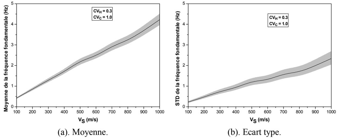
Figure 4.11: Intervalle de confiance de la fréquence fondamentale.
