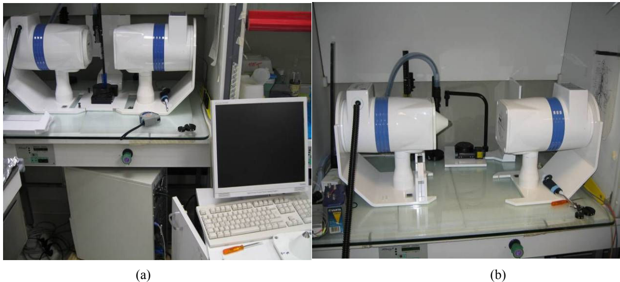
Figure V.1. Le \gamma Imager ; (a) les différents éléments du dispositif expérimental (deux têtes de détection, un appui noir entre les deux détecteurs pour tenir le fantôme et un ordinateur de contrôle) ; (b) les deux types de collimation disponibles (parallèle et pinhole).
