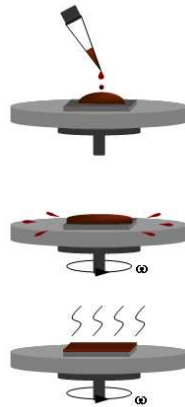
Figure 161 – Principe du procédé de centrifugation, spin coating
