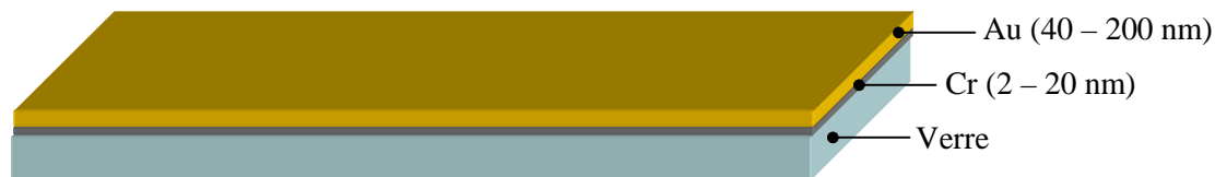
Figure 141 – Couches métalliques (Cr, Au) déposées sur la lame de verre
