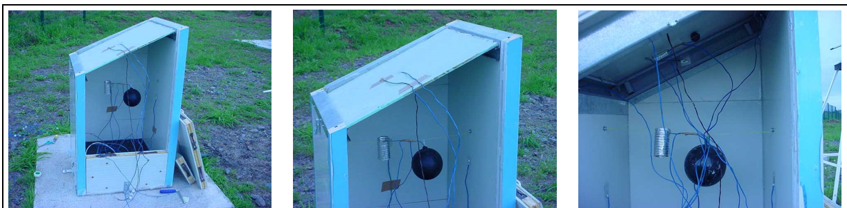
Figure 2 : Détails de l'assemblage et de l'instrumentation d'une cellule ISOTEST
