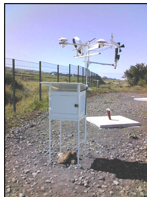
Figure 41 : Station météorologique; le mat de mesure de vitesse du vent est placé à environ 2m de hauteur
