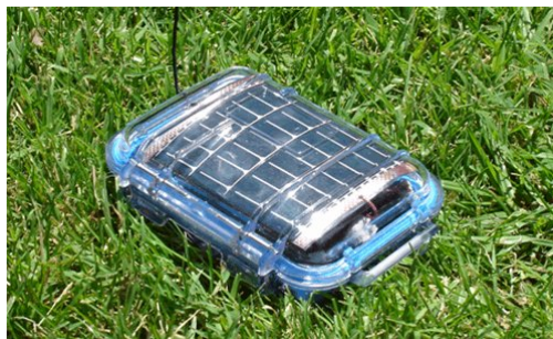
FIGURE I.9 – Heliomote, un nœud fonctionnant grâce à l'énergie solaire
