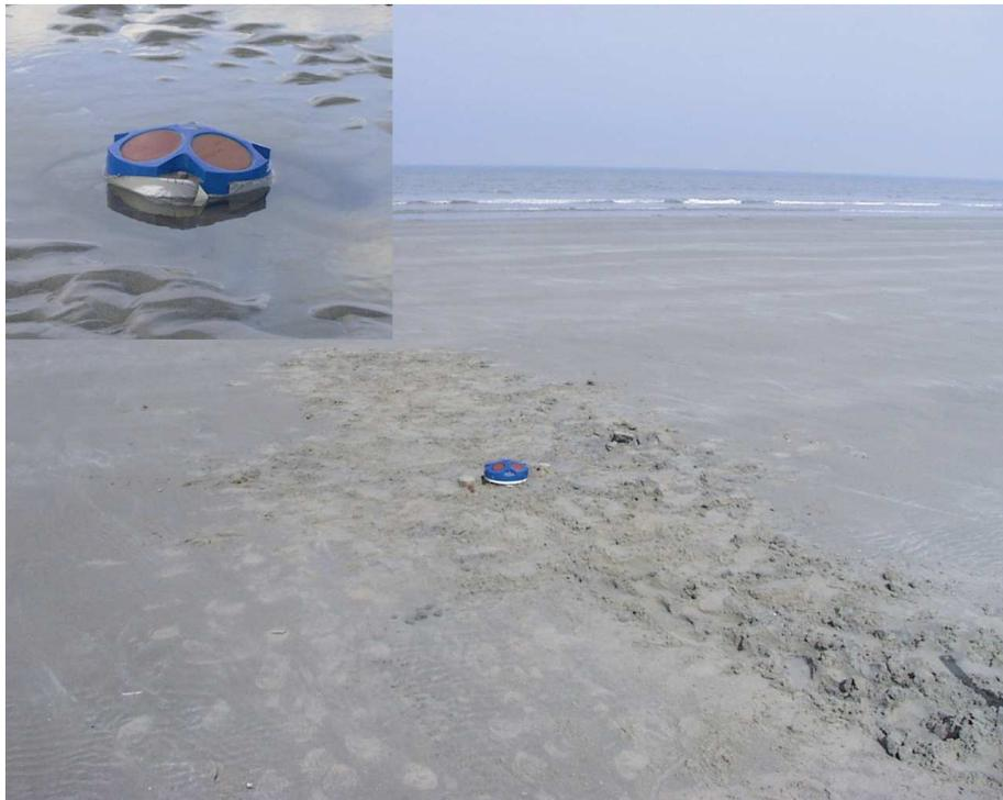
Figure.II.10 : Photographie d'un A.D.C.P mis en place sur l'estran du Clipon.
