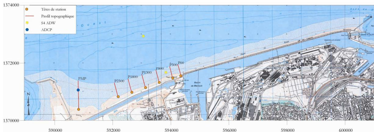
Figure.II.18 : Carte de localisation des appareils et des mesures réalisées au cours de la campagne de mars 2004. Source : Carte IGN 1/25000 de Dunkerque.
