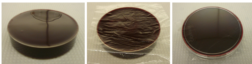
FIG. 4.4 – Fermeture hermétique des boîtes pour éviter l'oxydation lors de la coagulation du sang total.
